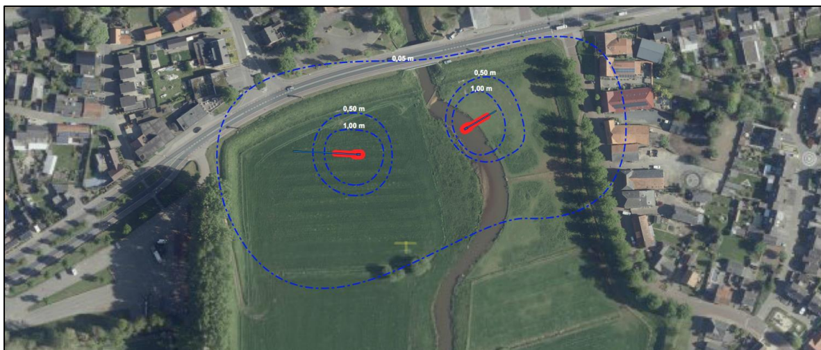
Figuur 8 – Grondwaterstandverlageningen [m] eerste watervoerend pakket (laag T1) onder best-guess condities .
