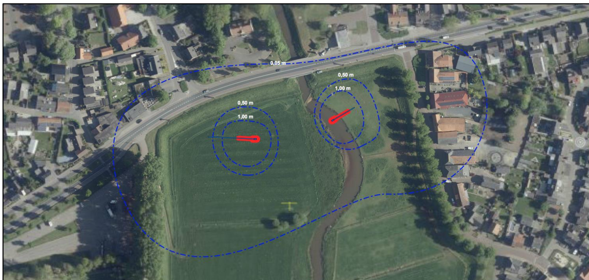
Figuur 7 – Grondwaterstandverlageningen [m] eerste watervoerend pakket (laag T1) onder worst-case condities .
