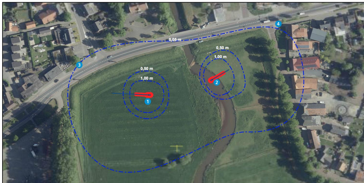
Figuur 13 – Peilbuislocaties t.b.v. monitoring grondwaterstandsverlagingen.
