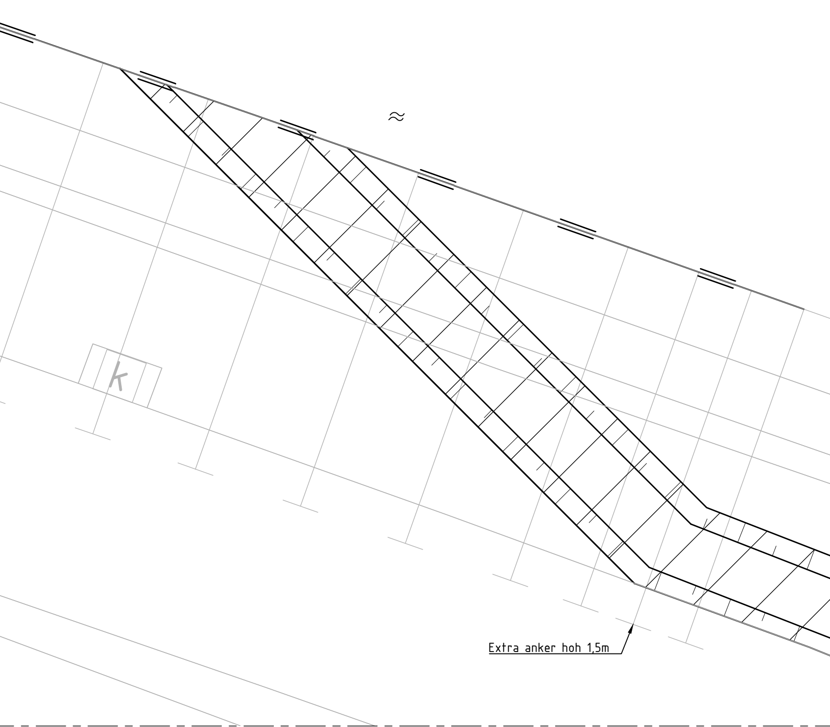
Detail 4: Bovenaanzicht aansluiting damwand / tuimelkade Schaal 1:100
