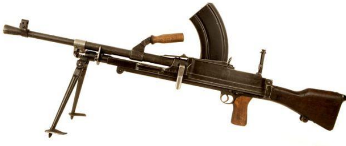
Afbeelding: Brits machinegeweer Bren MkII (kaliber .303)
