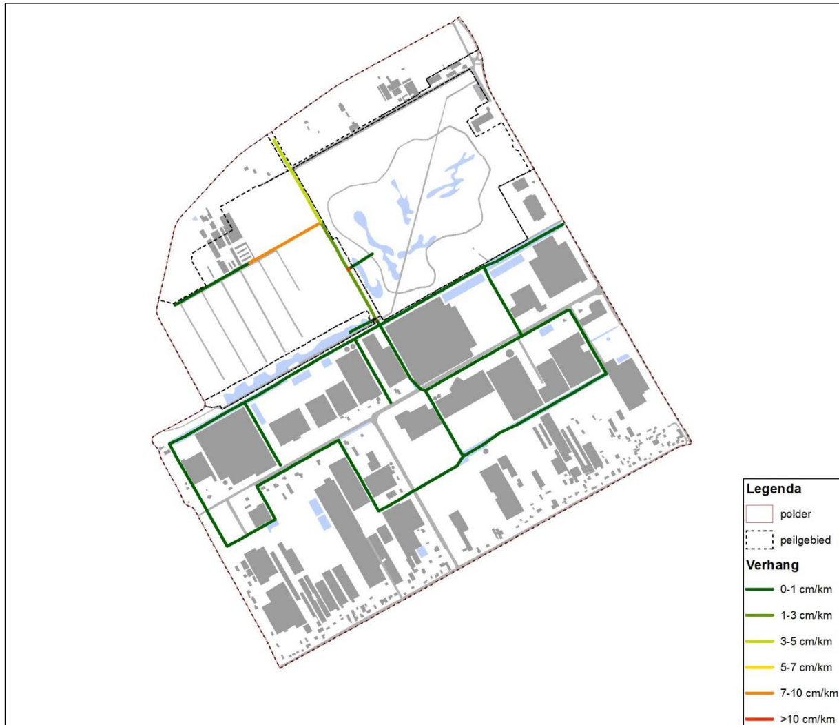
Figuur 4.1 Berekend verhang in watergangen bij normaalvoer
