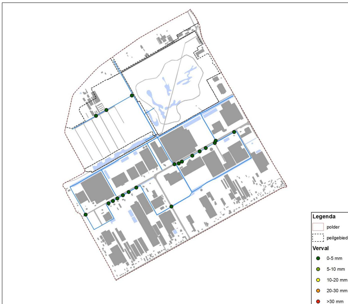
Figuur 4.2 Berekend verval over kunstwerken bij normaalvoer
