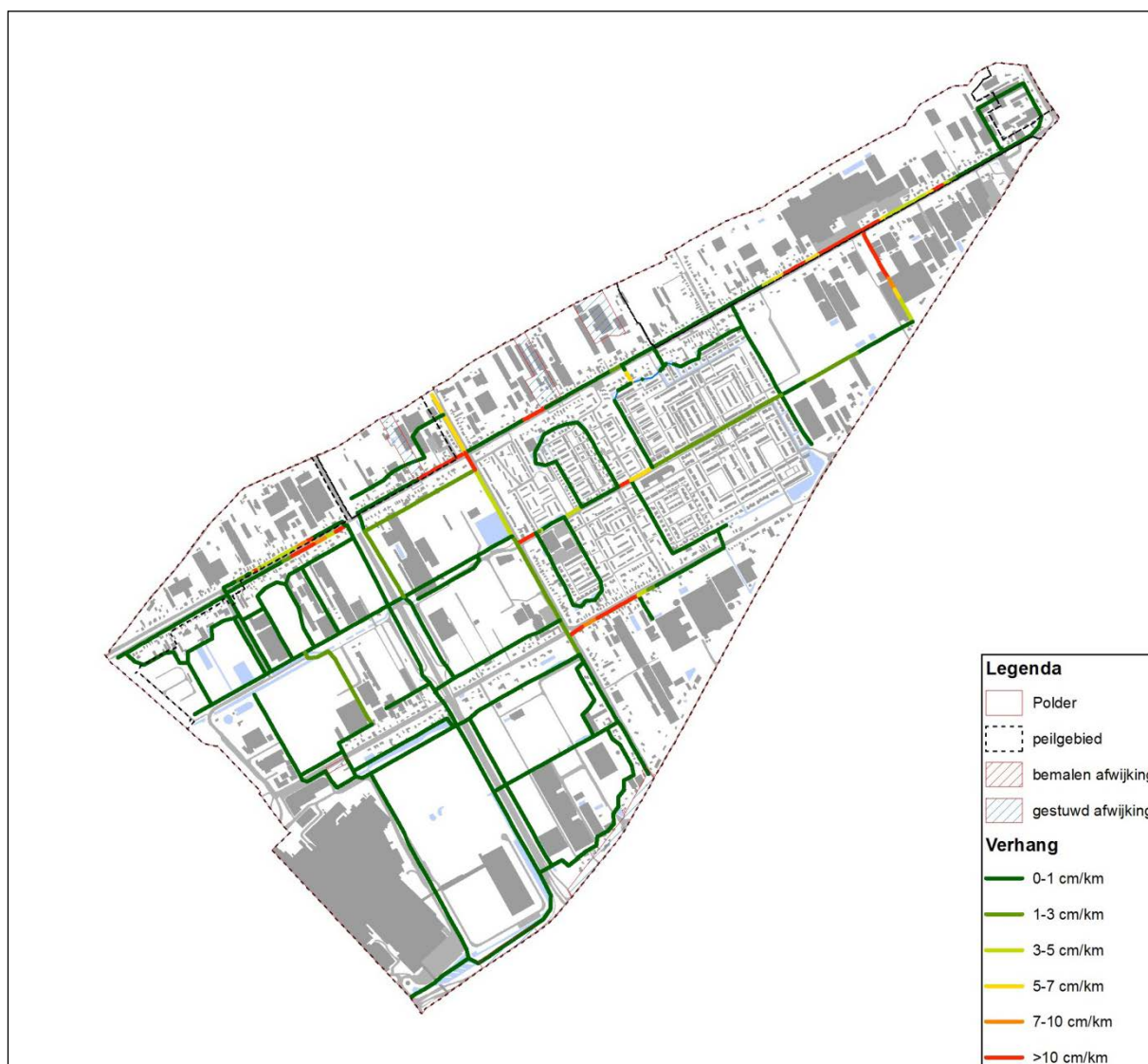
Figuur 4.1 Berekend verhang in watergangen bij normafvoer
