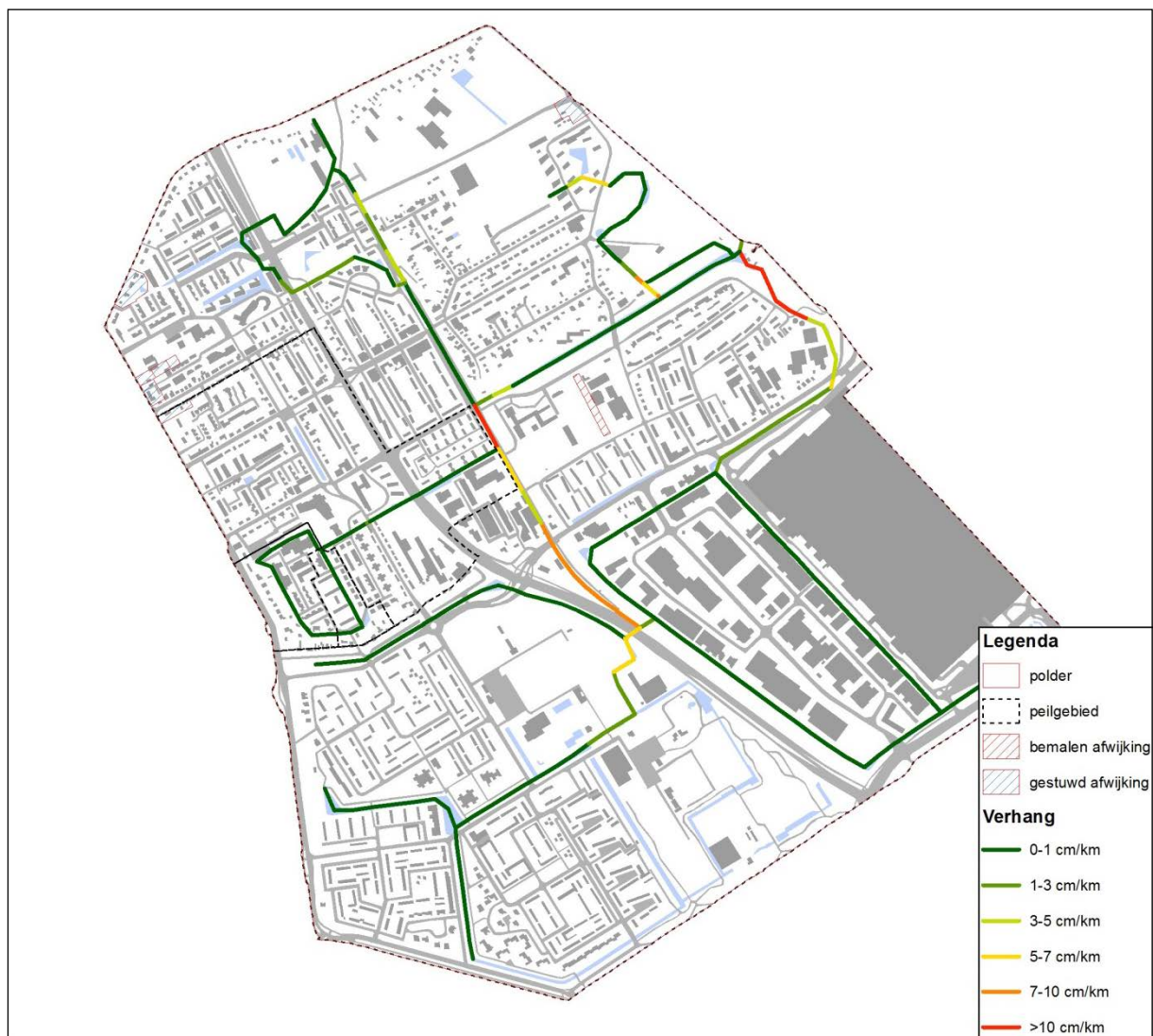
Figuur 4.1 Berekend verhang in watergangen bij normafvoer
