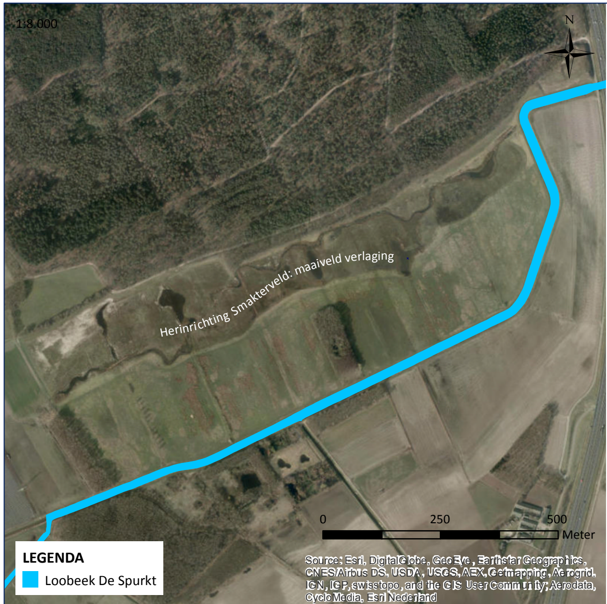
Figuur 15: Herinrichting Smakterveld. Van de door agrarisch gebruik verrijkte bovengrond is 30 à 40 cm afgegraven en afgevoerd.
