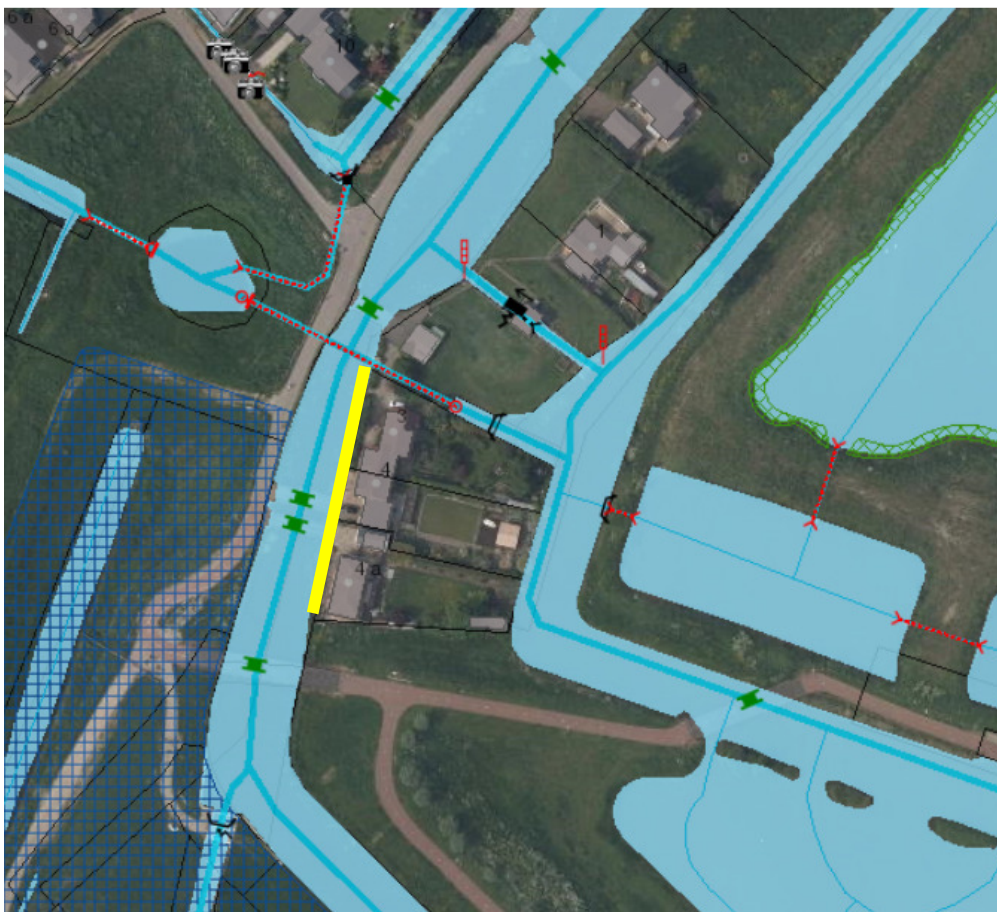
Figuur 3: De gele lijn geeft de locatie van de te wijzigen regionale kering aan ter plekke van de Bovenvaart 1 tot 4a (vak 26).
