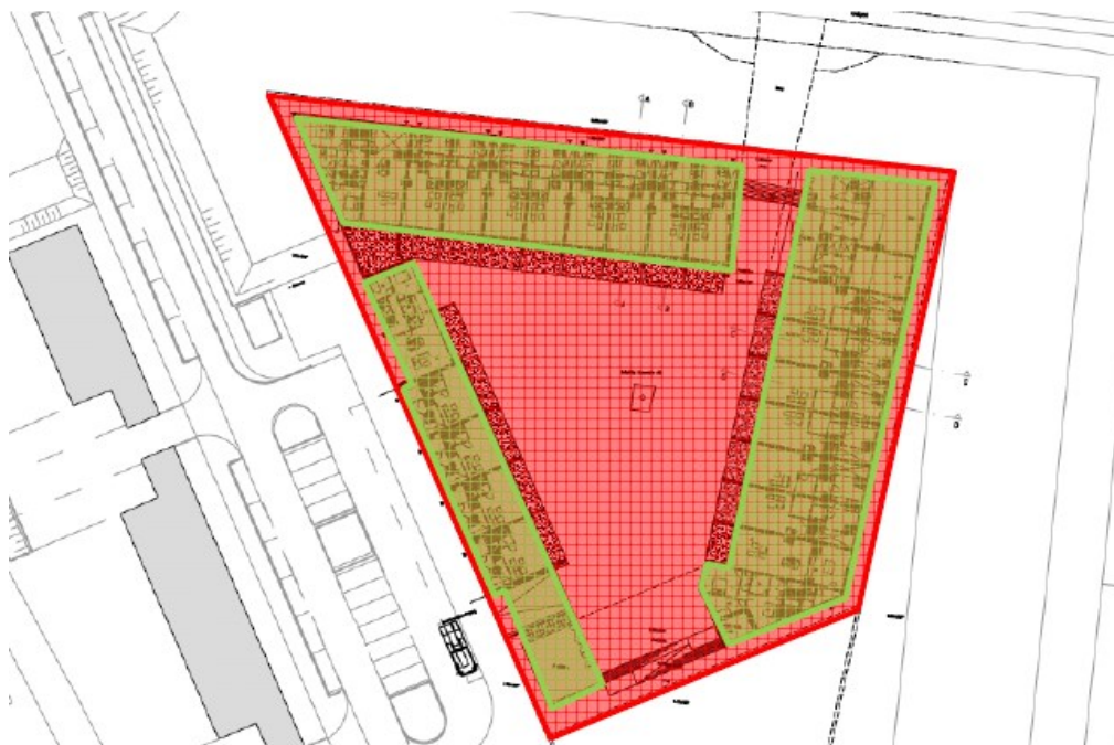
Figuur 2: Kelder waarop drie appartementengebouwen worden gerealiseerd.
