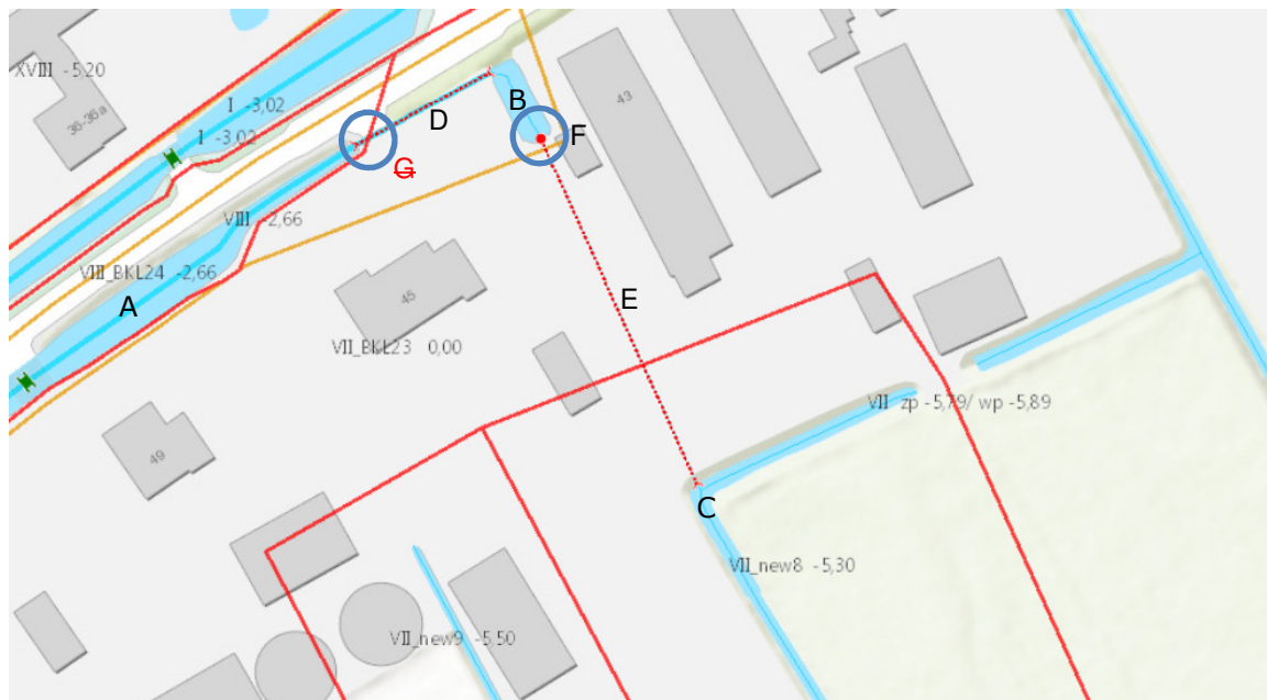
Figuur 4 Overzichtstekening van de ligging van de tussenboezem (A), vijver(B), polderwatergang(C) duikers(D en E) en inlaat (F en G, aangegeven met een blauwe cirkel).
