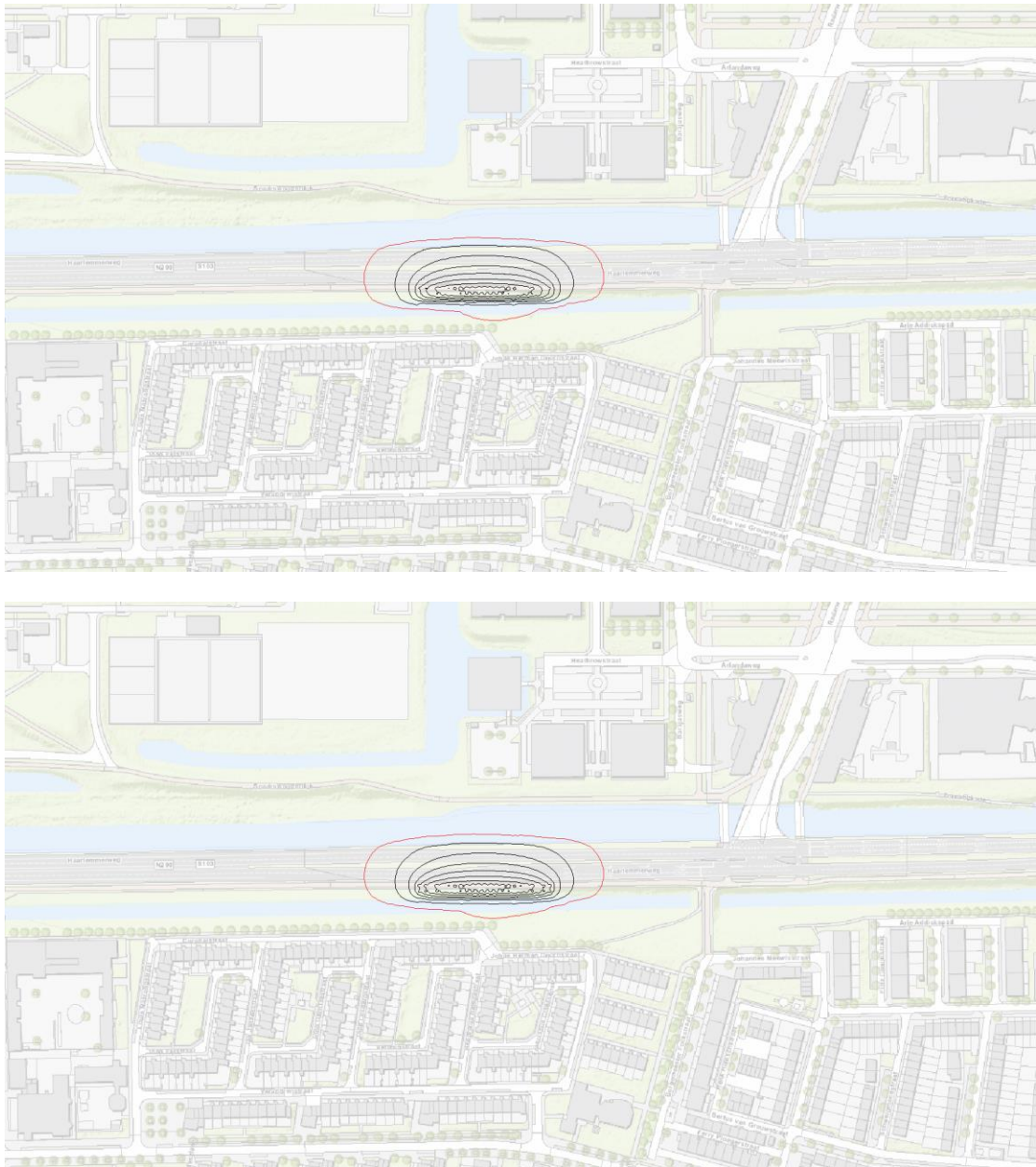
Figuur 92 Berekende grondwaterstandsverlaging in het freatische pakket na 28 dagen bemalen. De rode lijn geeft de 0,05 m verlagingsslijn aan, de isohypsen worden in stapjes van 0,20 m getekend waarbij de buitenste zwarte isohyps 0,20 m verlaging weergeeft. De bovenste kaart geeft de verlaging weer van het opgebrachte zand, de onderste kaart van het Hollandveen.
