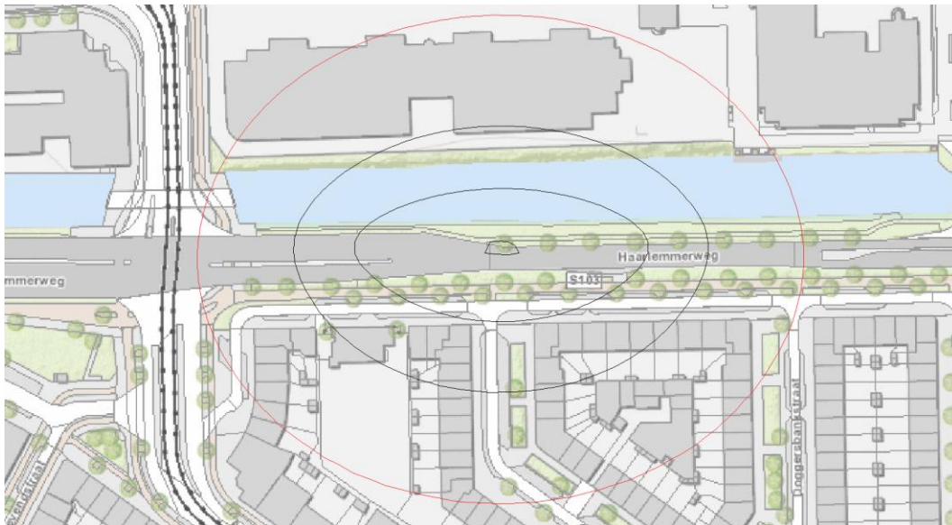
Figuur 148 Berekende grondwaterstandsverlaging in het wadzand na 21 dagen bemalen. De rode lijn geeft de 0,05 m verlaginglijn aan, de isohypsen worden in stapjes van 0,05 m getekend.
