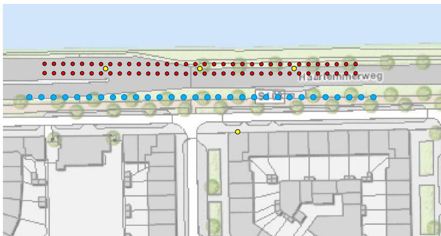
Figuur 145 Opzet van de retourbemaling. De rode stippen geven de 68 onttrekkingsfilters aan, deze zijn geplaatst in de bouwsleuf. In blauwde locaties van de 30 retourfilters tussen de sleuf en de te beschermen bebouwing. Ter hoogte van de vier gele stippen is het verloop van de stijghoogte tijdens de bemaling berekend.
