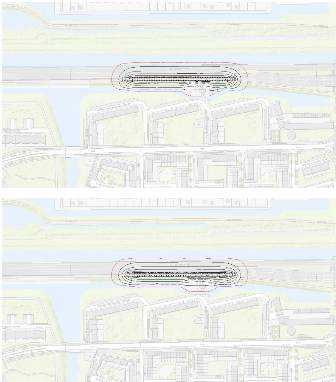
Figuur 62 Berekende grondwaterstandsverlaging in het freatische pakket na 7 dagen bemalen. De rode lijn geeft de 0,05 m verlagingsslijn aan, de isohypsen worden in stapjes van 0,20 m getekend waarbij de buitenste zwarte isohyps 0,20 m verlaging weergeeft. De bovenste kaart geeft de verlaging weer van het opgebrachte zand, de onderste kaart van het Hollandveen.
