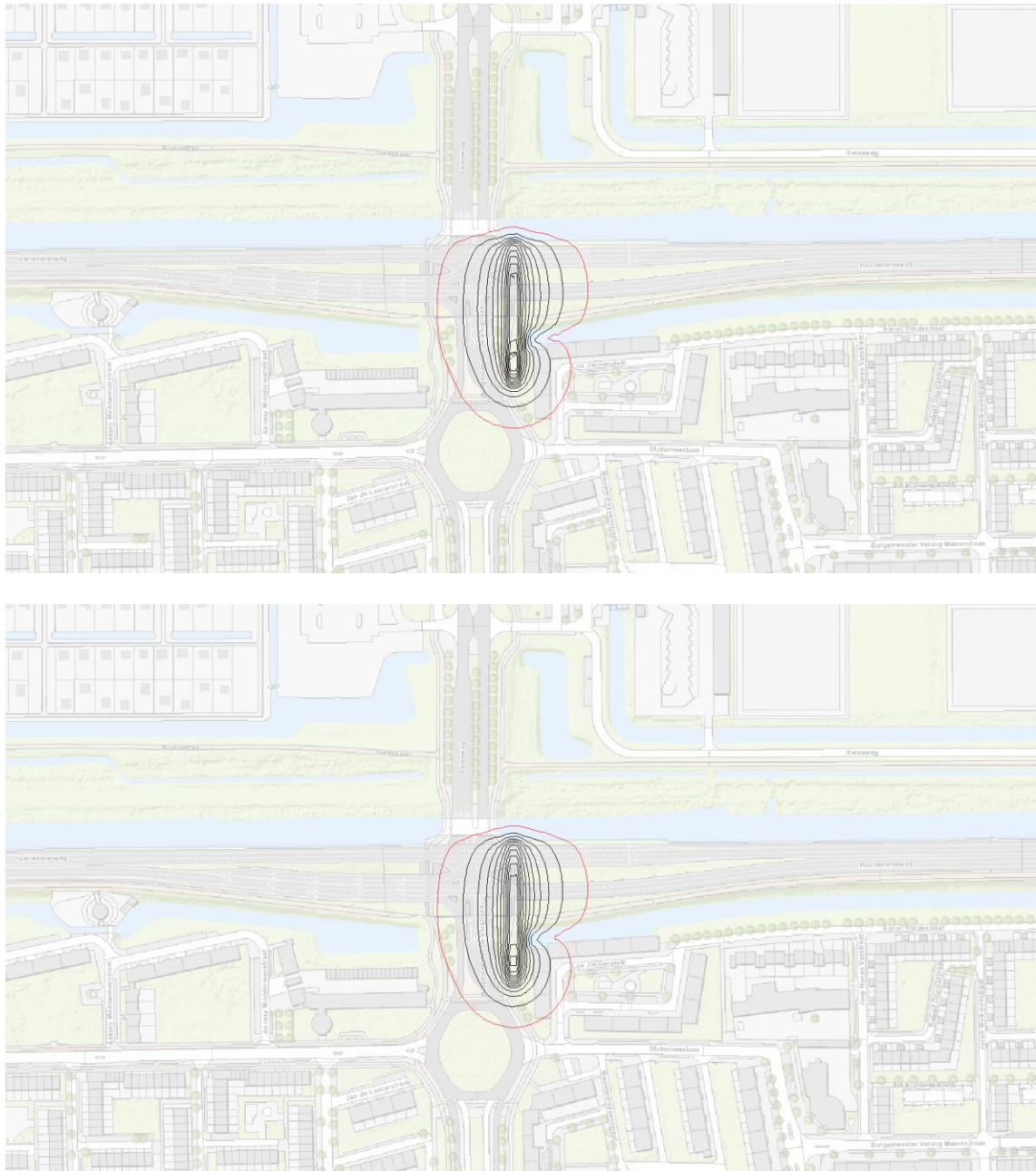
Figuur 77 Berekende grondwaterstandsverlaging in het freatische pakket na 14 dagen bemalen. De rode lijn geeft de 0,05 m verlaginglijn aan, de isohypsen worden in stapjes van 0,20 m getekend waarbij de buitenste zwarte isohyps 0,20 m verlaging weergeeft. De bovenste kaart geeft de verlaging weer van het opgebrachte zand, de onderste kaart van het Hollandveen.
