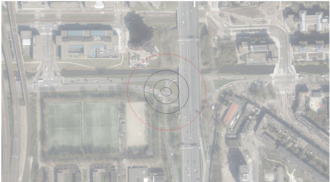
Figuur 103 Berekende grondwaterstandsverlaging in het wadzand na 28 dagen bemaalen. De rode lijn geeft de 0,05 m verlaginglijn aan, de isohypsen worden in stapjes van 0,05 m getekend.
