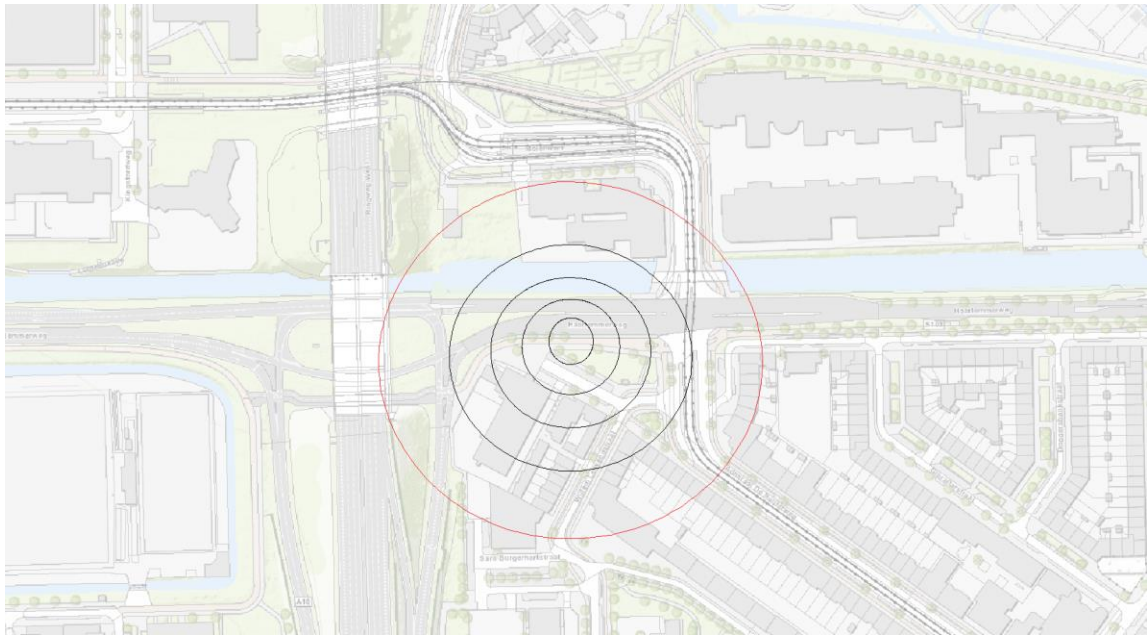
Figuur 129 Berekende grondwaterstandsverlaging in het wadzand na 56 dagen bemalen. De rode lijn geeft de 0,05 m verlagingsslijn aan, de isohypsen worden in stapjes van 0,05 m getekend.
