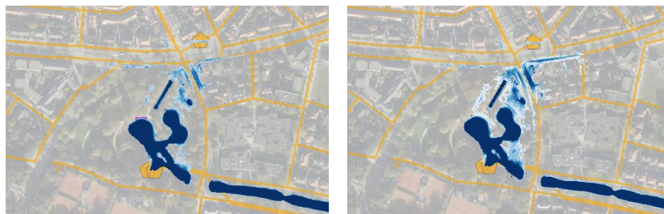
Figuur 3-2: Inundatie vanuit het oppervlaktewater (links 2 x rond 1000; rechts 2x rond 600 (open))
