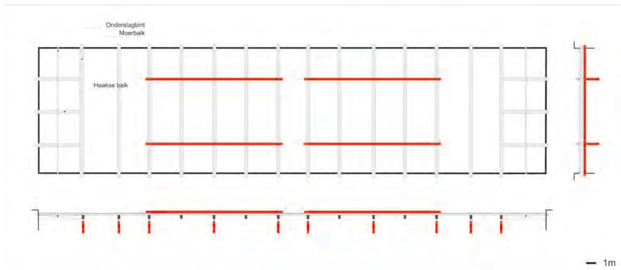
Afb. 59 Documentatietekening waarin de negentiende-eeuwse moerbalken van de zoldervloer zijn ingetekend (grijs), alsmede de stalen spanten en balken die in 1950 zijn aangebracht (rood). Kinderbinten uit de negentiende eeuw zijn alleen in de dwarsdoorsnede getekend om de hoofdstructuur beter inzichtelijk te krijgen.
