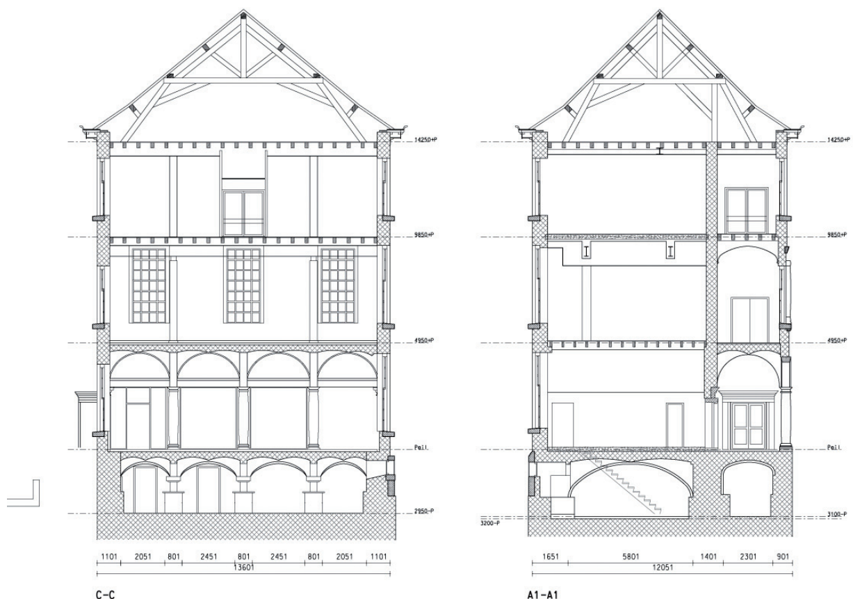
Afb. 15 Twee maal een dwarsdoorsnede, links over de zaalvleugel, rechts over de stadsvleugel met de vloerconstructies weergegeven.
