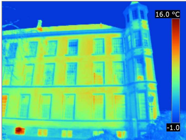
Figuur 22 Aanzicht van de rechter zijde van de zuidvleugel; Deze afbeelding dient ter indicatie: de gevel heeft kortstondig bezonning ontvangen waardoor de getoonde oppervlaktetemperaturen een vertekend beeld geven
