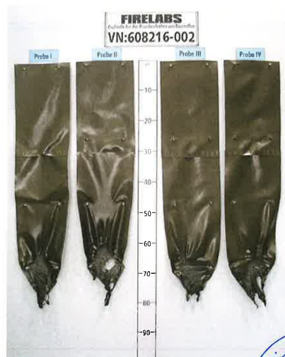
Bild 4 Aussehen des Probekörpers nach dem Brandversuch
