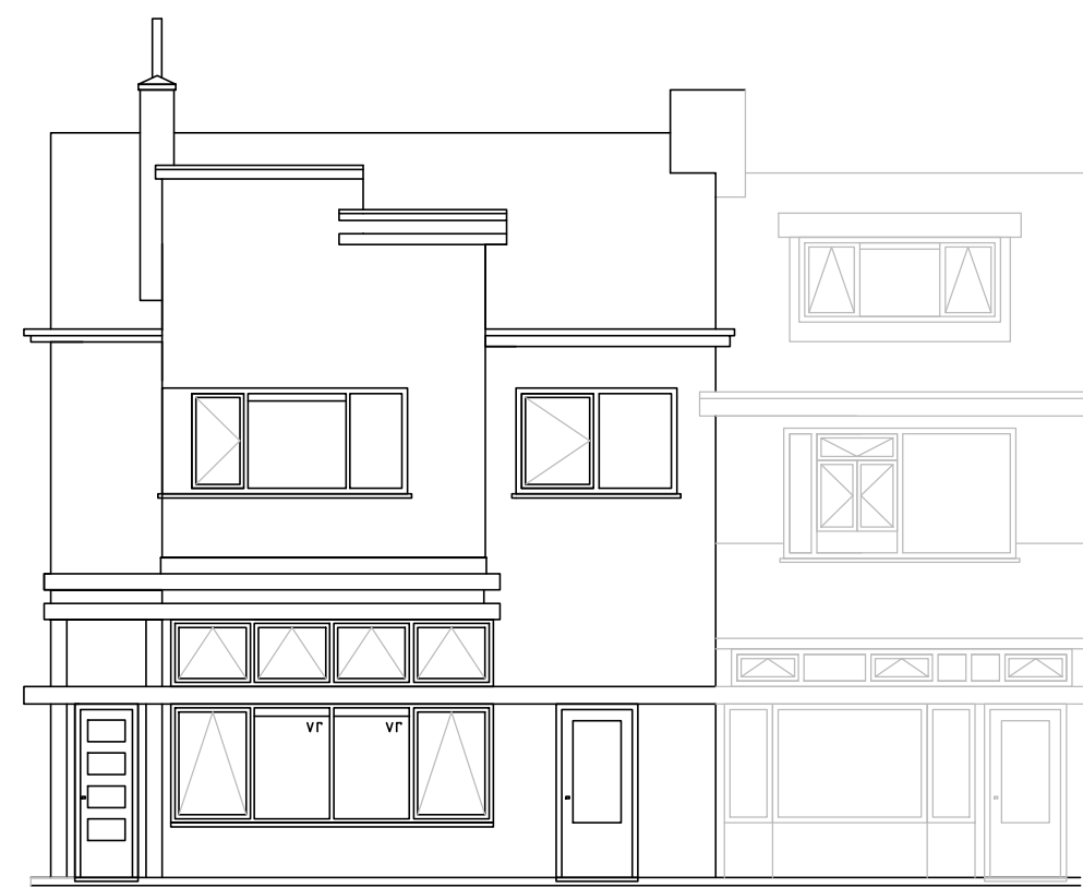
Gevel nieuw zijde Burgemeester de Bordesplein kozijn aanpassing begane grond 1x
