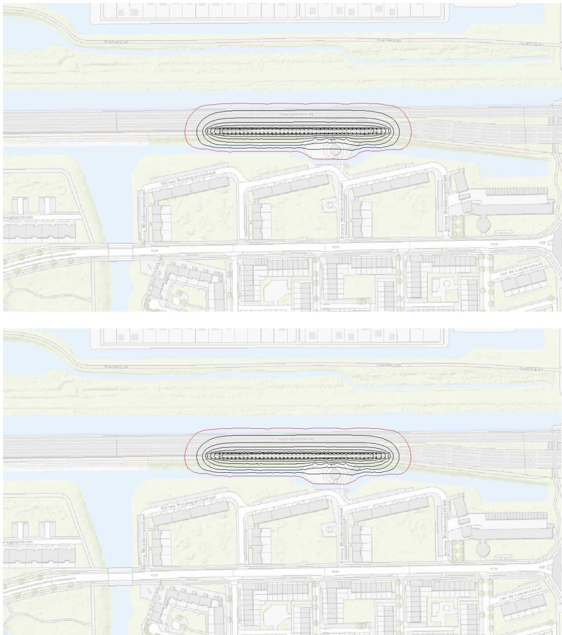
Figuur 62 Berekende grondwaterstandsverlaging in het freatische pakket na 7 dagen bemalen. De rode lijn geeft de 0,05 m verlagingsslijn aan, de isohypsen worden in stapjes van 0,20 m getekend waarbij de buitenste zwarte isohyps 0,20 m verlaging weergeeft. De bovenste kaart geeft de verlaging weer van het opgebrachte zand, de onderste kaart van het Hollandveen.
