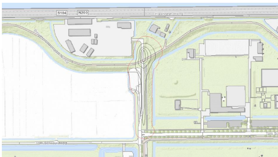
Figuur 19 Berekende grondwaterstandsverlaging in het freatische pakket na 21 dagen bemalen. De rode lijn geeft de 0,05 m verlaginglijn aan, de isohyps worden in stapjes van 0,20 m getekend waarbij de buitenste zwarte isohyps 0,20 m verlaging weergeeft.
