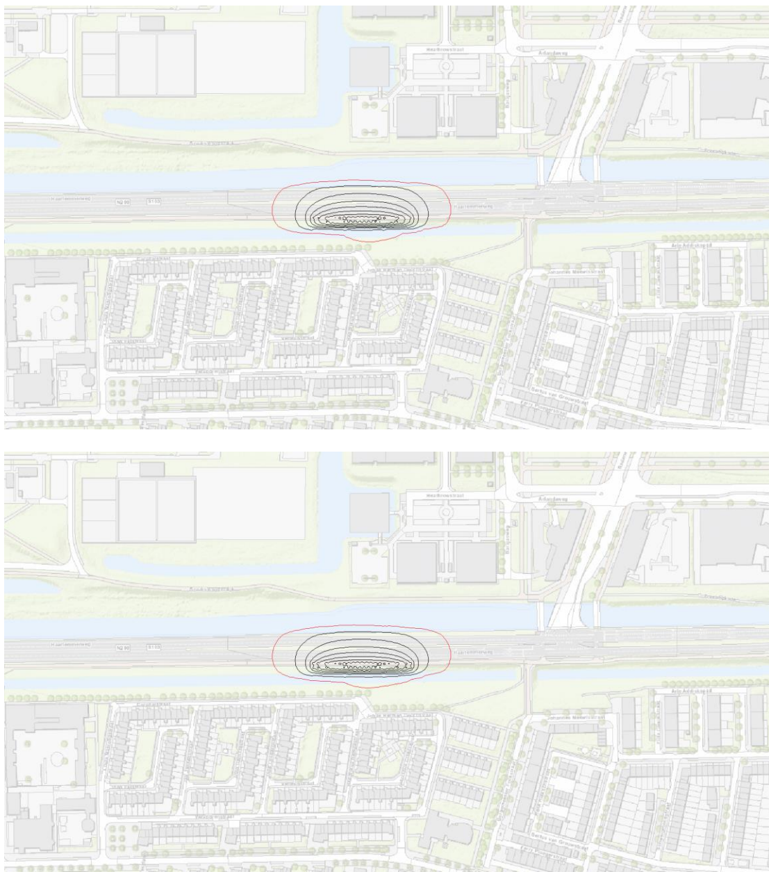
Figuur 92 Berekende grondwaterstandsverlaging in het freatische pakket na 28 dagen bemalen. De rode lijn geeft de 0,05 m verlagingsslijn aan, de isohypsen worden in stapjes van 0,20 m getekend waarbij de buitenste zwarte isohyps 0,20 m verlaging weergeeft. De bovenste kaart geeft de verlaging weer van het opgebrachte zand, de onderste kaart van het Hollandveen.
