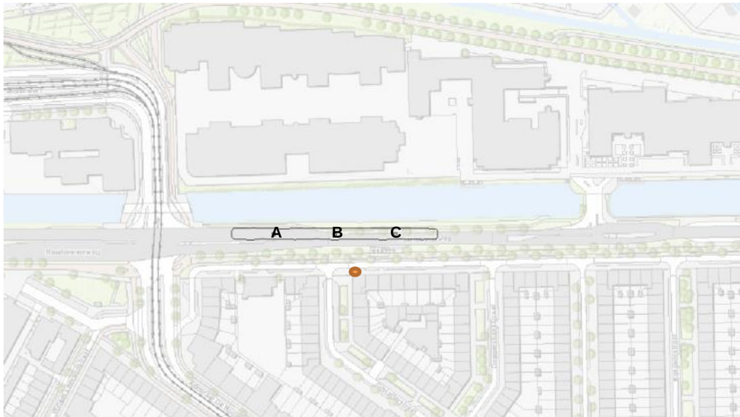
Figuur 140 Locatie A, B en C, waarvan in figuur 139 de berekende grondwaterstanden worden geplot. De oranje stip is de locatie waar de verlaging onder de bebouwing wordt geanalyseerd in relatie tot de bekende hoogte van de houten palen.
