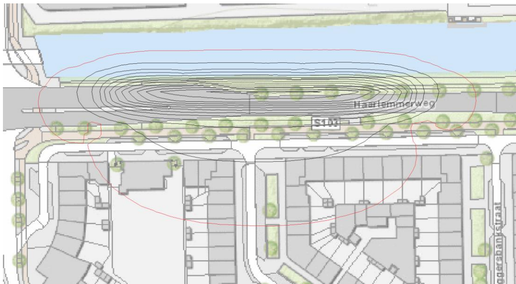
Figuur 147b Berekende grondwaterstandsverlaging in het freatische pakket (Hollandveen) na 21 dagen bemalen. De rode lijn geeft de 0,05 m verlaginglijn aan, de isohypsen worden in stapjes van 0,20 m getekend waarbij de buitenste zwarte isohyps 0,20 m verlaging weergeeft.
