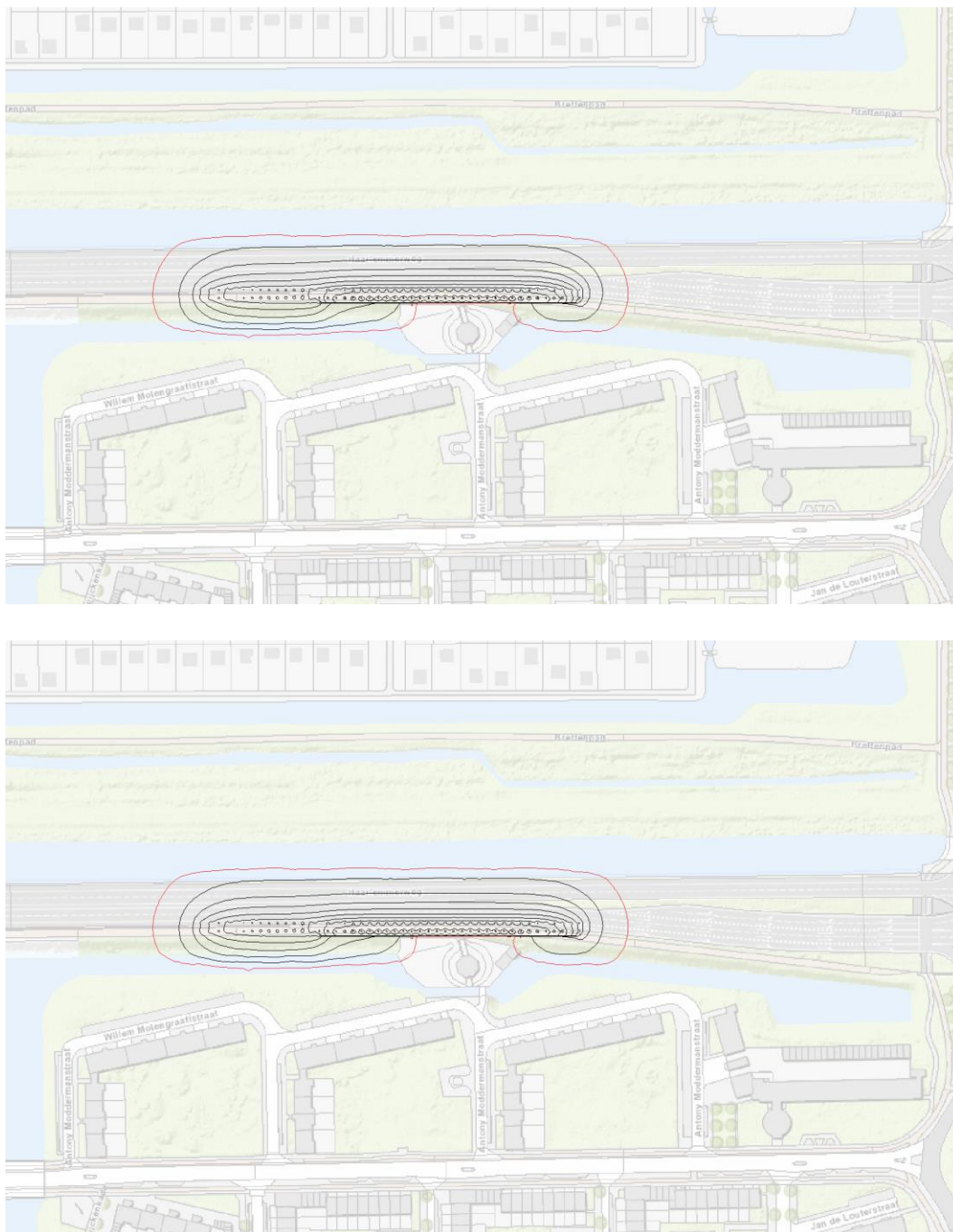
Figuur 72 Berekende grondwaterstandsverlaging in het freatische pakket na 7 dagen bemalen. De rode lijn geeft de 0,05 m verlaginglijn aan, de isohypsen worden in stapjes van 0,20 m getekend waarbij de buitenste zwarte isohyps 0,20 m verlaging weergeeft. De bovenste kaart geeft de verlaging weer van het opgebrachte zand, de onderste kaart van het Hollandveen.
