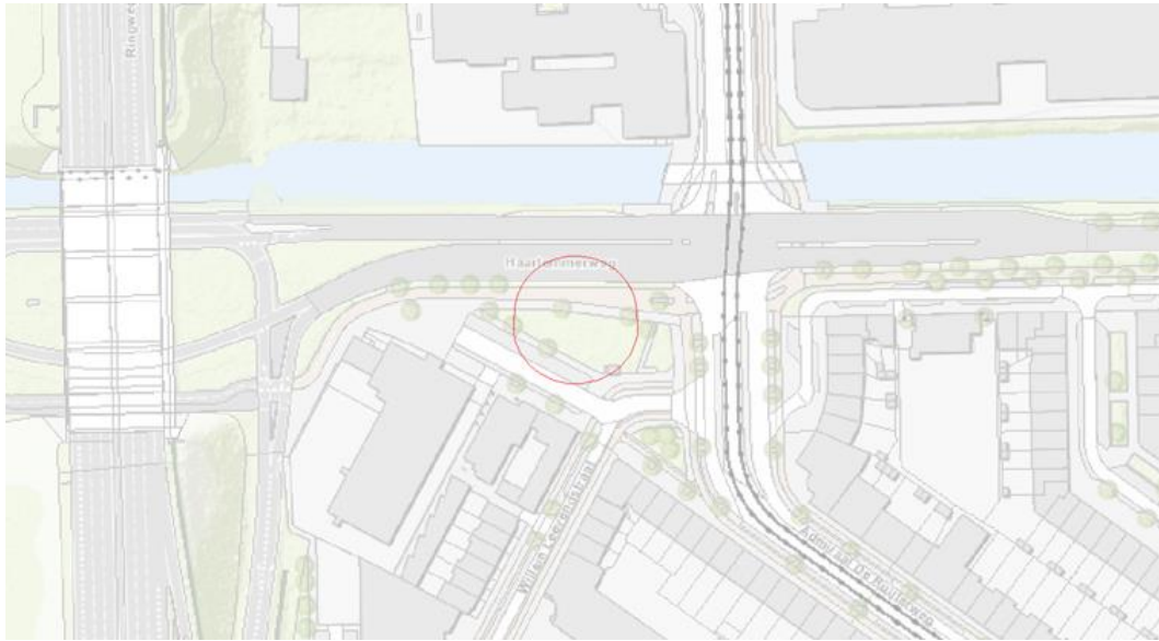
Figuur 124 Berekende grondwaterstandsverlaging in het wadzand na 7 dagen bemalen. De rode lijn geeft de 0,05 m verlaginglijn aan. Vanwege de geringe verlaging zijn er geen andere isohypsen getekend.
