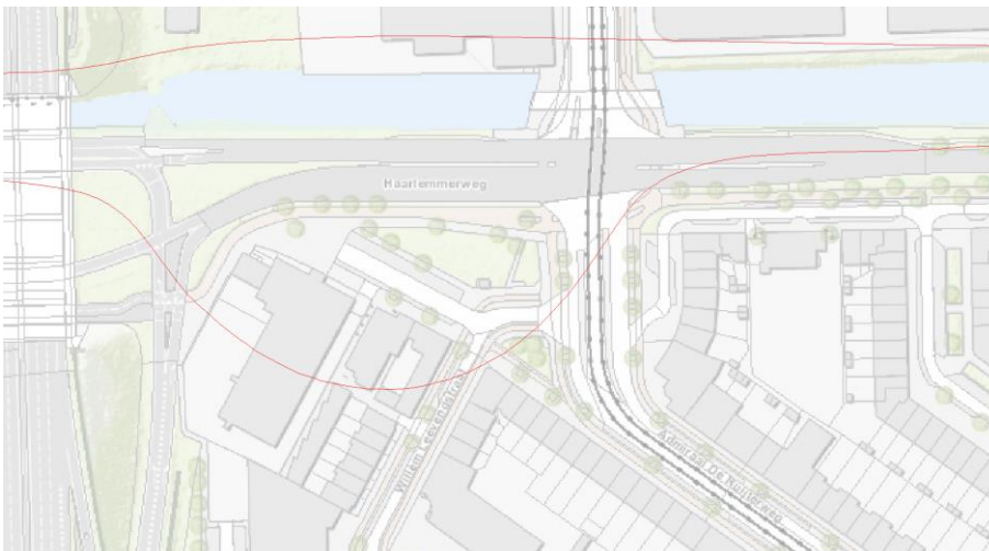
Figuur 132 Berekende isohyps van NAP -0,50 m in het freatische pakket, aan het einde van de bemaling van 56 dagen.
