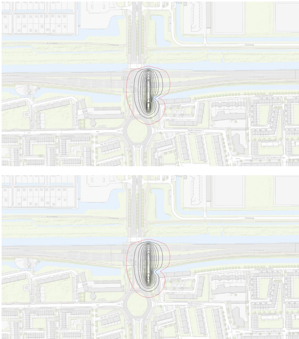
Figuur 77 Berekende grondwaterstandsverlaging in het freatische pakket na 14 dagen bemalen. De rode lijn geeft de 0,05 m verlaginglijn aan, de isohypsen worden in stapjes van 0,20 m getekend waarbij de buitenste zwarte isohyps 0,20 m verlaging weergeeft. De bovenste kaart geeft de verlaging weer van het opgebrachte zand, de onderste kaart van het Hollandveen.
