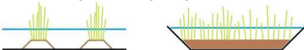
Figuur 1. Ontwerp van dammen om inzwemmen van vis te beperken (Aveco de Bondt, 2018).
