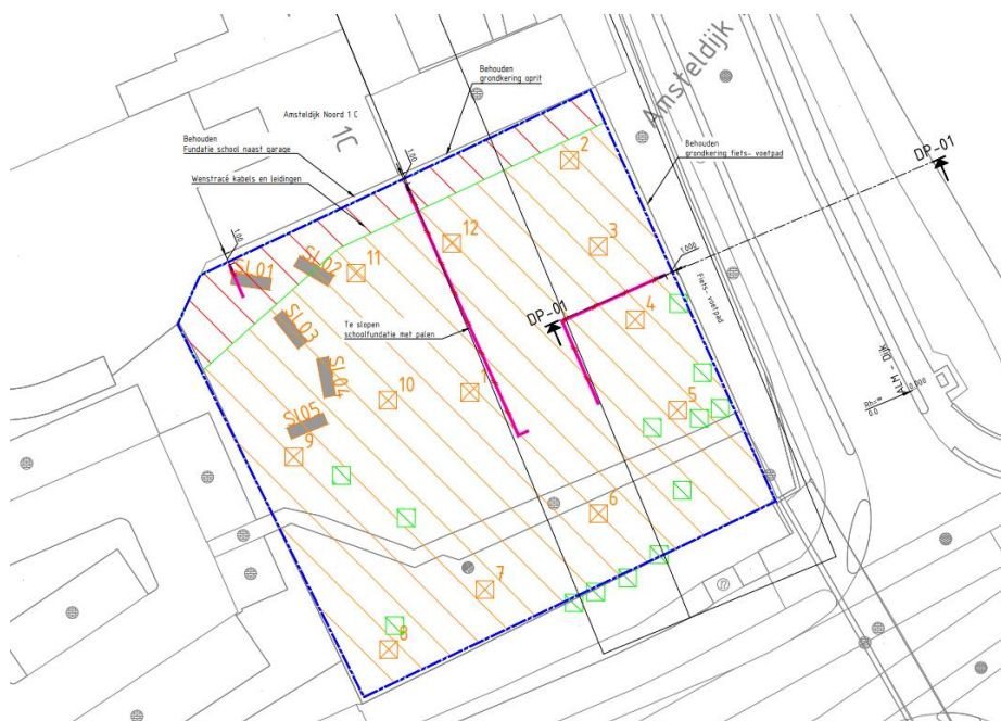
Figuur 1 - Overzichtstekening te slopen fundatie school
