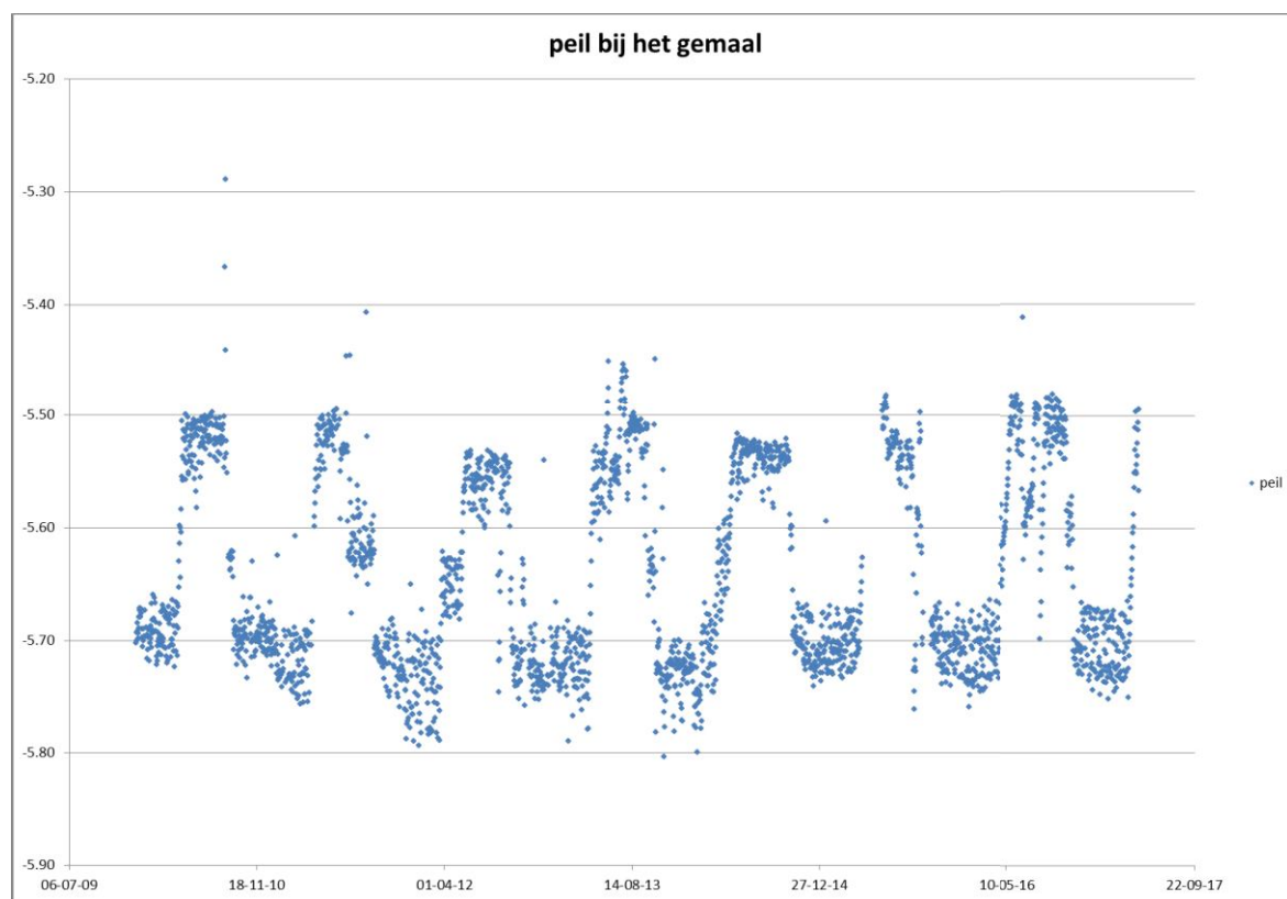
Figuur 3.12 Geregistreerd peil bij het gemaal
