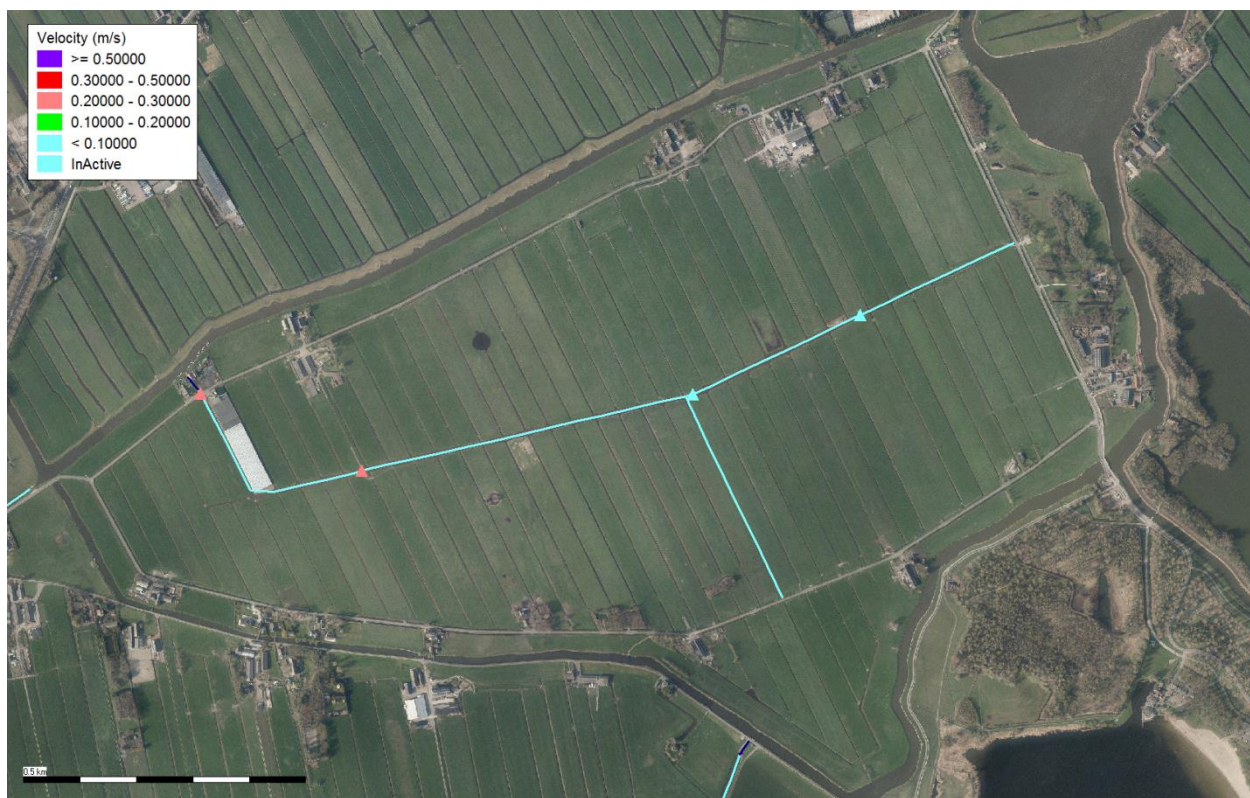
Figuur 4-5 Berekende stroomsnelheid bruggen in primaire watergangen
