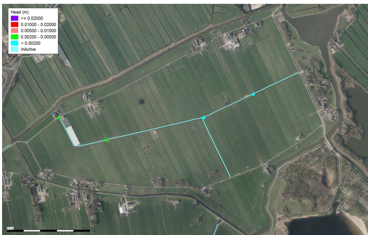
Figuur 4-6 Berekende opstuwing bruggen in primaire watergangen
