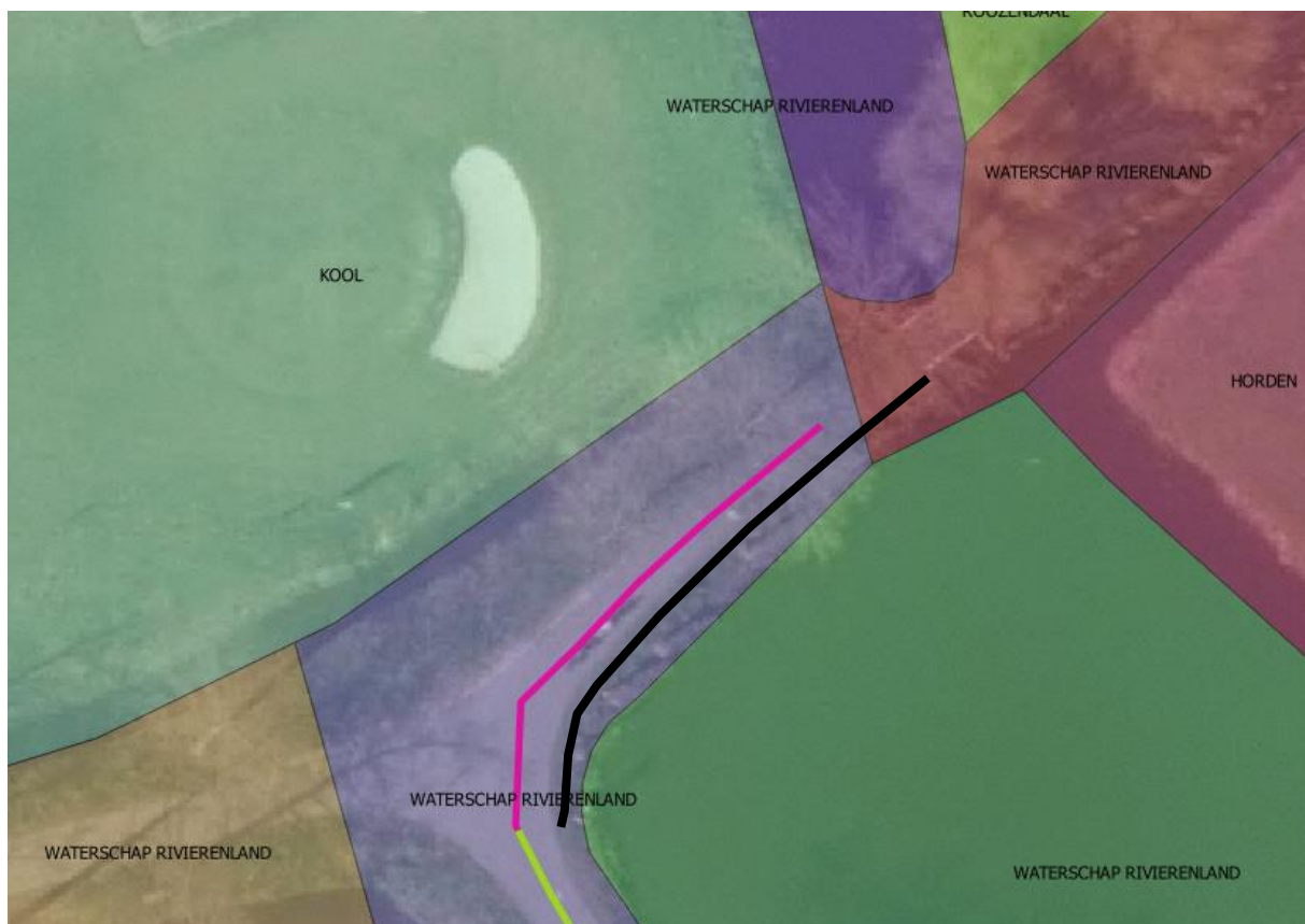
Figuur 5-2 Eigendomssituatie sectie Noorden in de huidige situatie. De roze lijn is de leggerlijn van sectie Noorden, de zwarte lijn geeft de locatie van de nieuwe damwand (type I constructie) weer.
