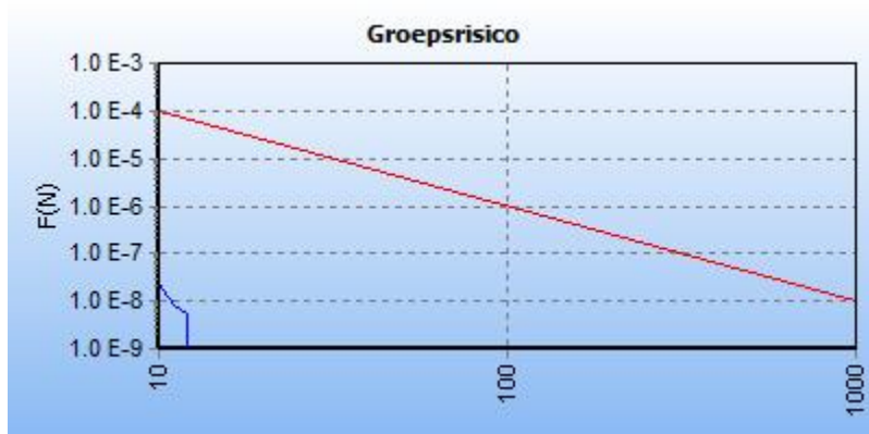
5.3 Figuur 5.3 FN curve voor 4629_leiding-A-665-deel-1 van N.V. Nederlandse Gasunie voor de kilometer tussen stationing 3180.00 en stationing 4180.00
