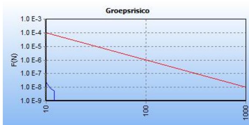
Figuur 2.19: fN-curve buisleiding A-665 ná planrealisatie
