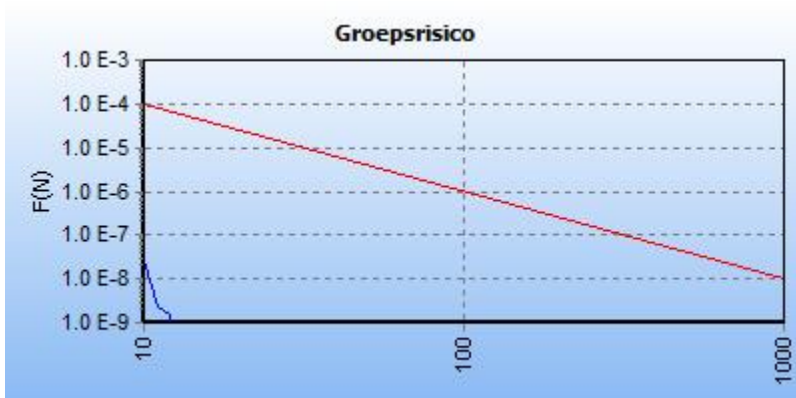
5.2 Figuur 5.2 FN curve voor 4629_leiding-A-578-deel-1 van N.V. Nederlandse Gasunie voor de kilometer tussen stationing 3050.00 en stationing 4050.00
