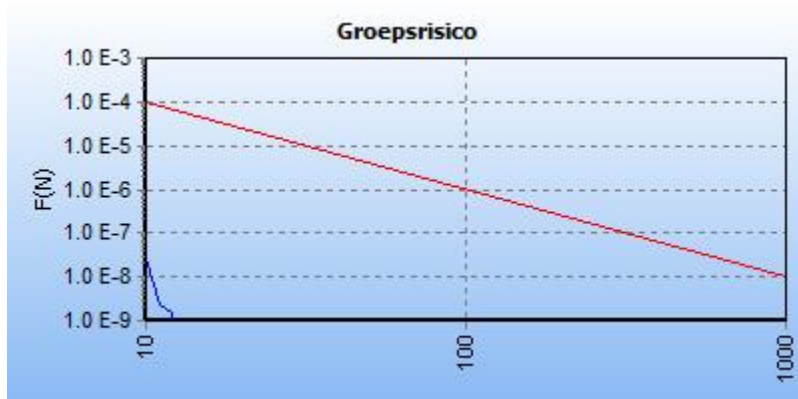
Figuur 2.13: fN-curve buisleiding A-578 vóór planrealisatie
