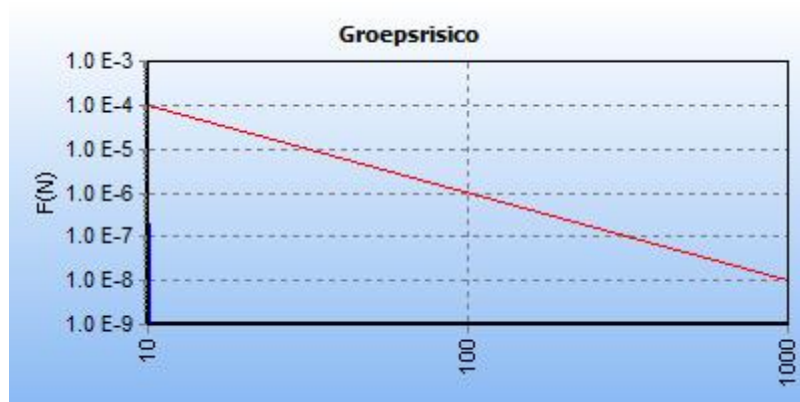
Figuur 2.9: fN-curve buisleiding A-520 ná planrealisatie
