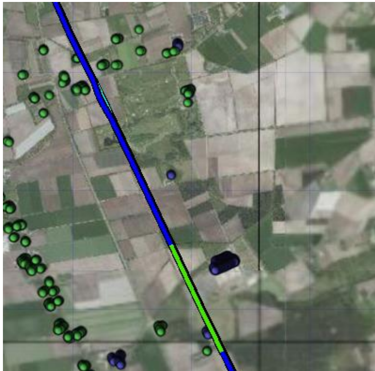
Figuur 2.11: Kilometer leiding met hoogste overschrijdingsfactor (in groen weergegeven) vóór planrealisatie
