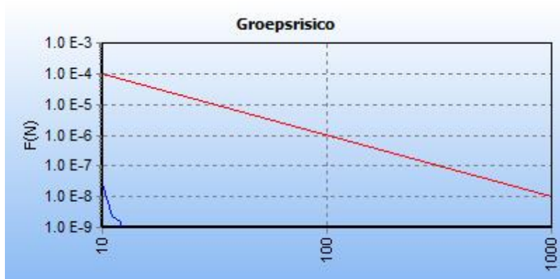
Figuur 2.14: fN-curve buisleiding A-578 ná planrealisatie
