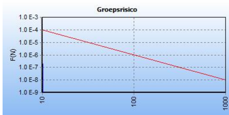
Figuur 2.8: fN-curve buisleiding A-520 vóór planrealisatie
