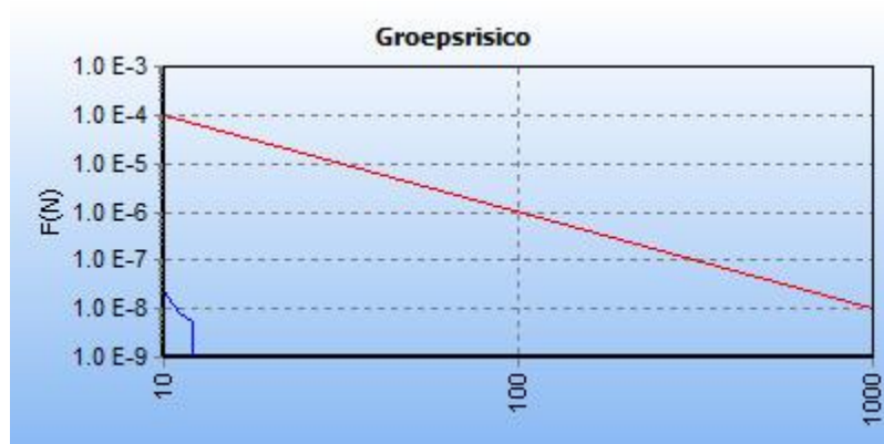
Figuur 2.18: fN-curve buisleiding A-665 vóór planrealisatie
