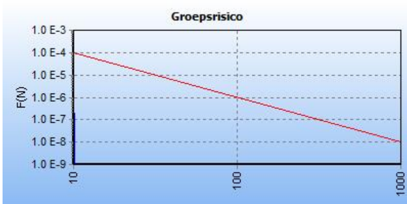
5.2 Figuur 5.2 FN curve voor 4629_leiding-A-578-deel-1 van N.V. Nederlandse Gasunie voor de kilometer tussen stationing 3050.00 en stationing 4050.00
