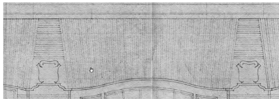
2 3 Rolllagen en details als gevelbekroning
