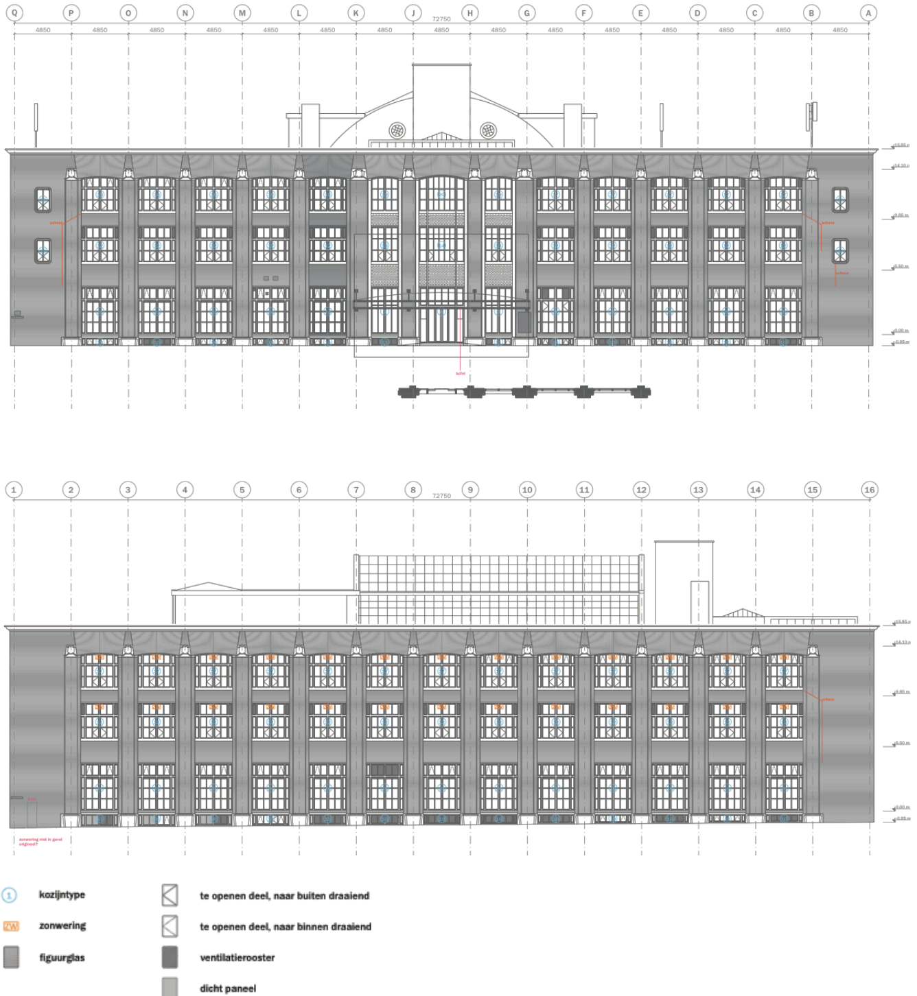
12.1 – Typologie van aangetroffen ramen en deuren in noord en oostgevel (uit: MEI bouwtechnische opname, pp 22, 23)
