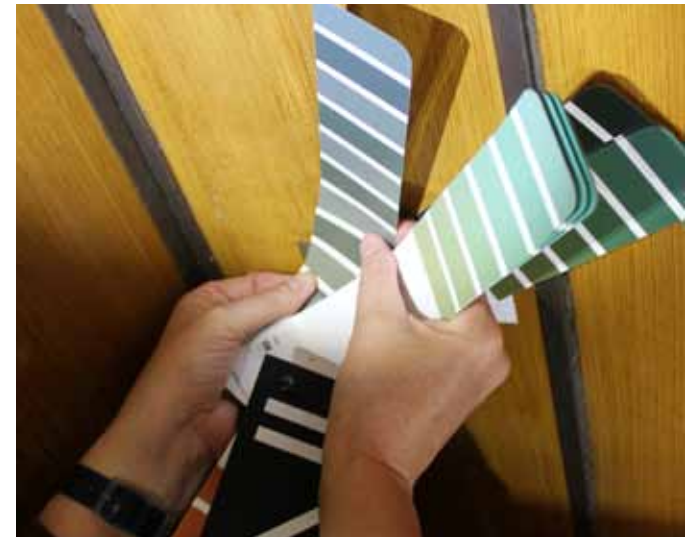
afb 6 - Coderen van de kleur van vrijgelegde verflagen aan de hand van een kleurenwaaier met NCS kleurcoderingen
