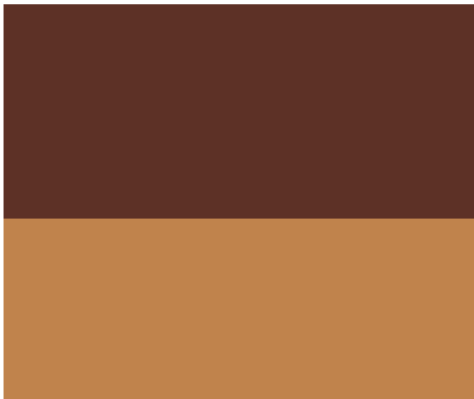
afb 24 - Digitale kleurstenen van de sauslaag NCS S 7020 - Y20R (boven) van houtimitatie 1 en de basistoon NCS S 3040 - Y30R (onder) van houtimitatie 1. (bron: website NCS, d.d. 17 april 2017)
