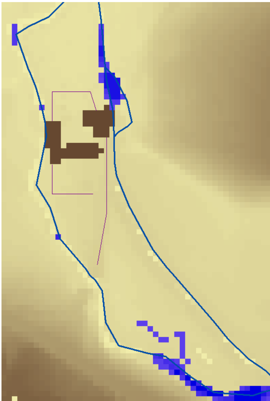
Figuur 5.2: inundatiepatroon bij een afvoer van ca. 4,8 m 3 /s in actuele situatie
