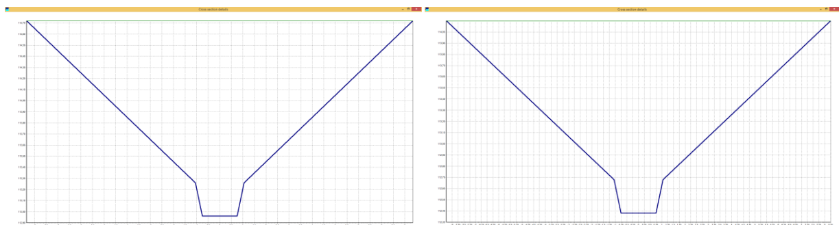
Figuur 11: dwarsprofielen vistrap bovenstroomse zijde (lange variant)
