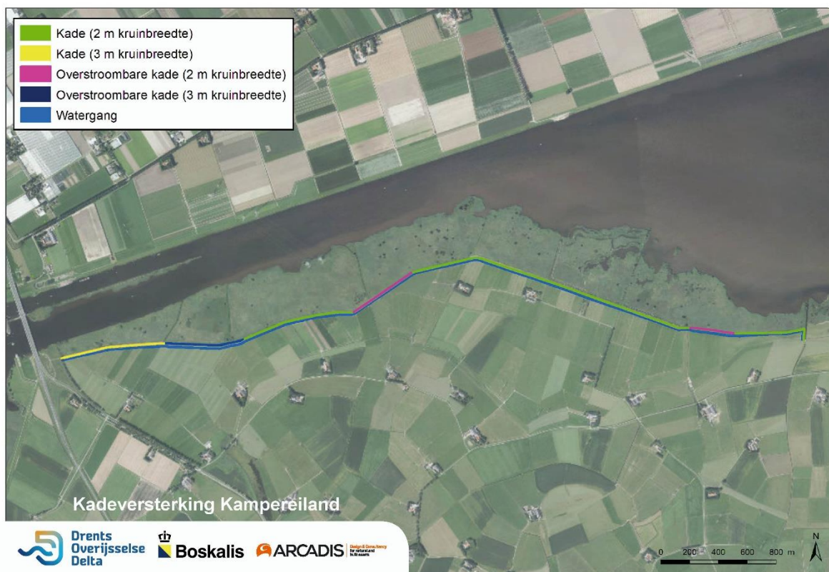
Figuur 4: Overzicht maatregelen in de Willem Meyer- en Stikkenpolder (dijkring 101). De groene en gele lijn geven de niet-overstroombare delen weer met respectievelijk 2 meter of 3 meter kruinbreedte. De paarse en donkerblauwe lijn geven de overstroombare delen weer met respectievelijk 2 meter of 3 meter kruinbreedte. De nieuw te graven watergang loopt langs de binnenteen van de kering.
