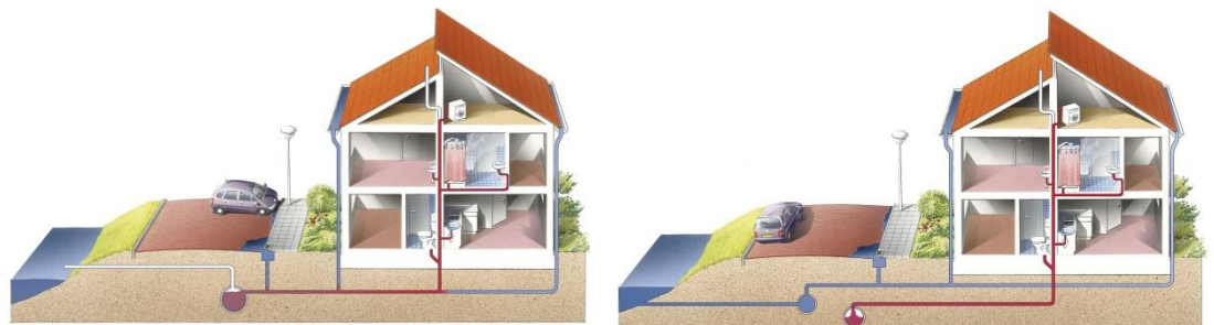
Figuur 6-1: Riolering onder de grond (links: gemengde riolering; rechts: gescheiden riolering) (Bron: Paul Maas, Tilburg/Stichting RIONED)
