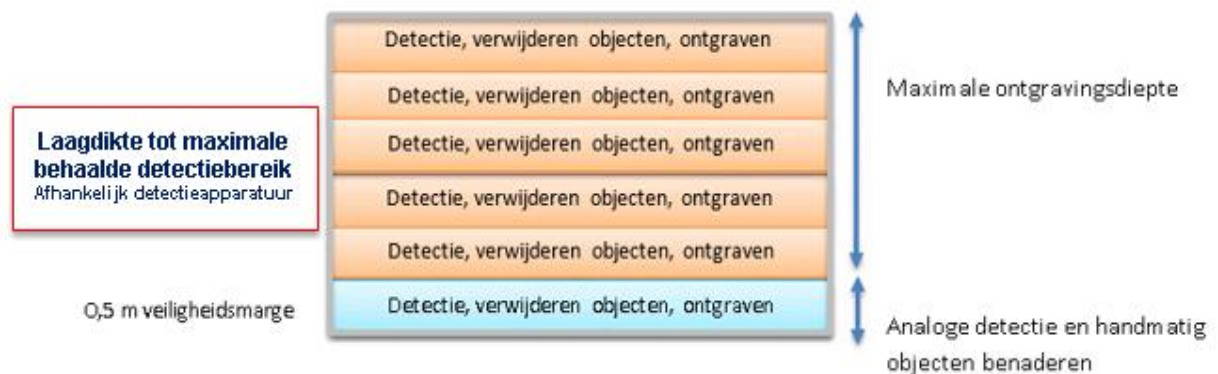
Figuur 15: Schematische weergave werkmethode laagsgewijze oppervlakedetectie
