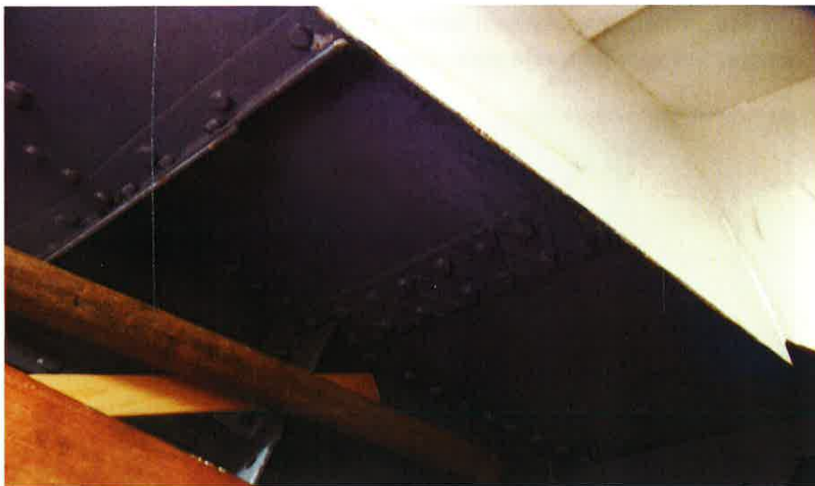
Afbeelding 5 onderdeks resten klinknagels (foto 491)
