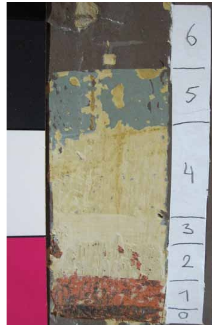
afb 35 - Hoekstijl liftschacht in kelder met op het metaal (0) een menie (1) en meerdere gele lagen (2-4), dan de grijze afwerking uit 1959 (5) en de bruine afwerking (6) die nu in het zicht is (stratigrafie 2.06)
