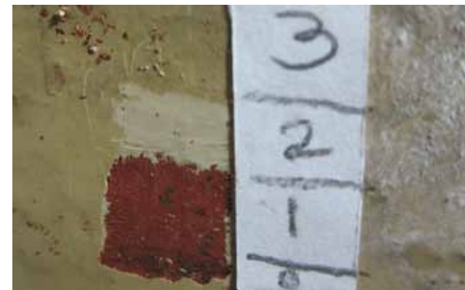
afb 33 - Lagenpakket een schoor op atriumniveau (exterieur). Op het metaal (0) is een menie (1) te zien en daarna in twee lagen de lichtgele afwerking (2/3) in (vermoedelijk) olieverf (stratigrafie 2.21).
