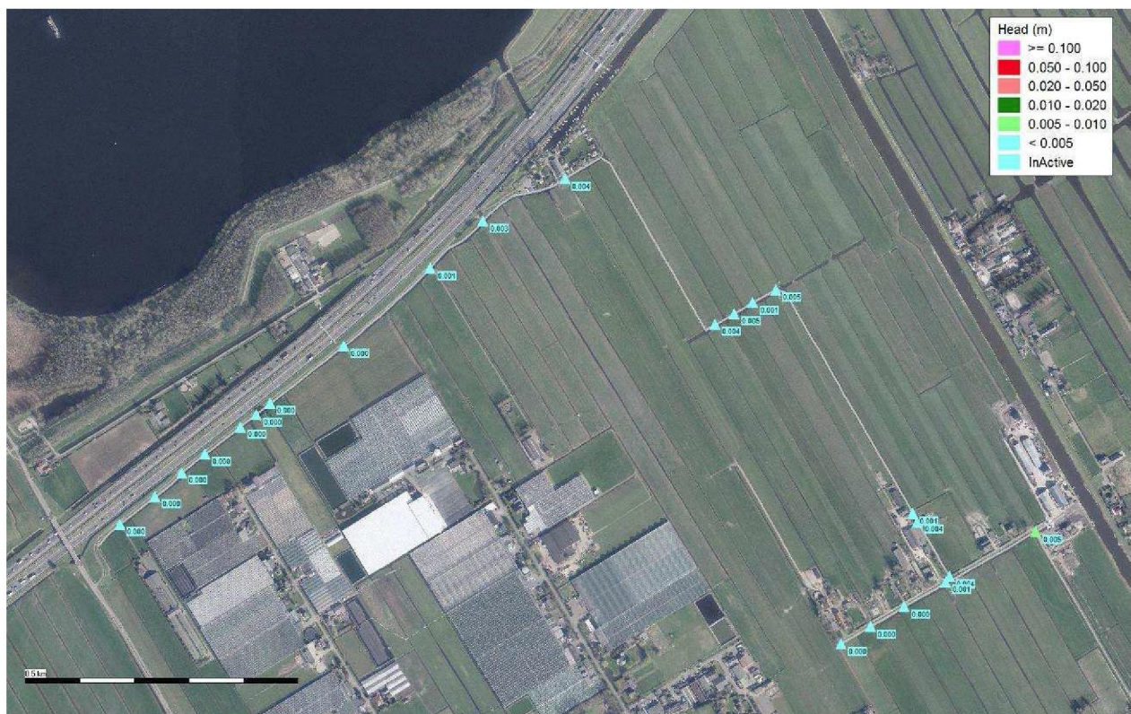
Figuur 7: Berekende opstuwing kunstwerken (bruggen en duikers) bij winterpeil
