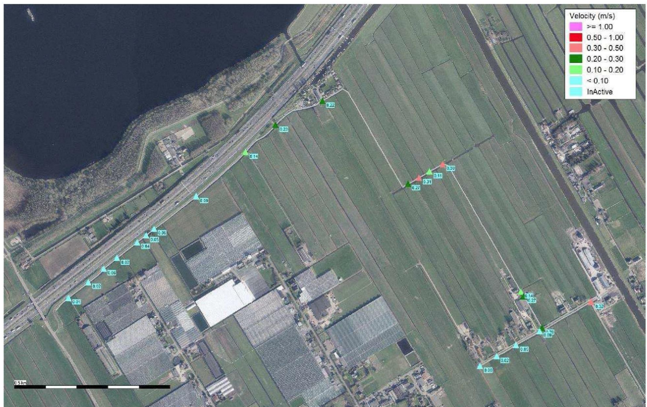
Figuur 8: Berekende stroomsnelheid kunstwerken (bruggen en duikers) bij winterpeil
