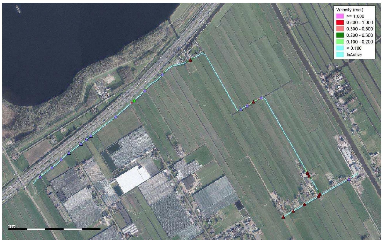
Figuur 9 : Berekende stroomsnelheid primaire watergangen bij winterpeil
