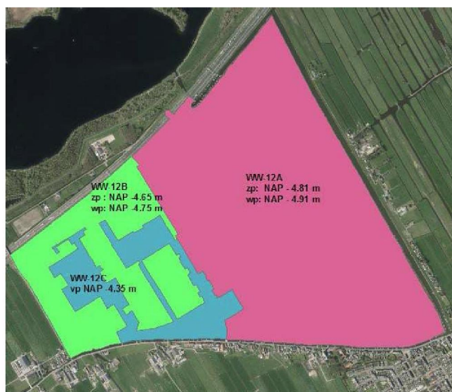
Figuur 1: indeling peilvakken rekenschema Meeslouwerpolder
