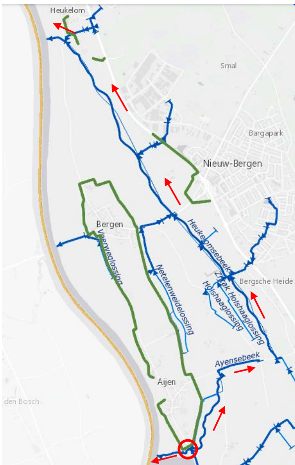
Figuur 2 Afwatering tijdens afdammen Aijensebeek
