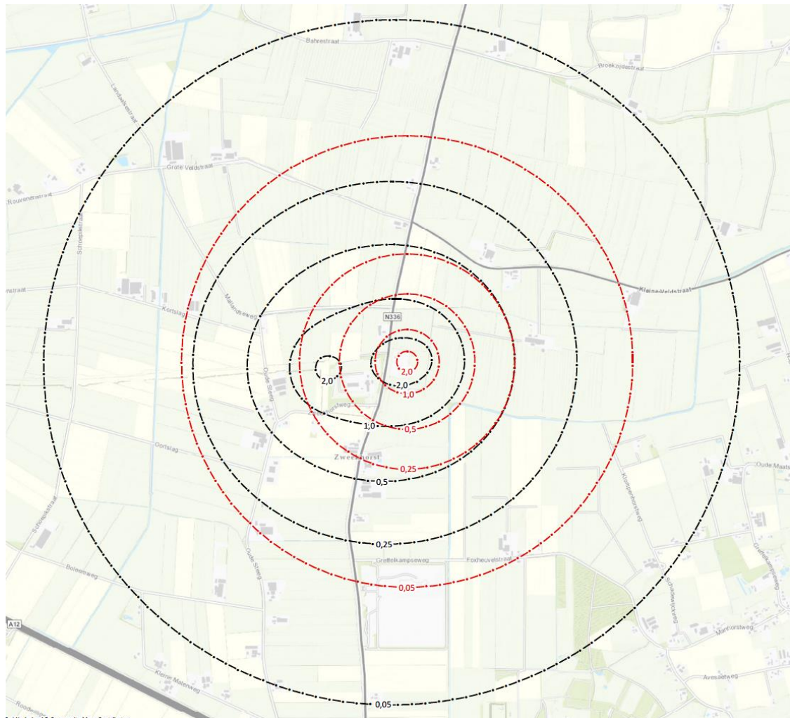
Figuur 2.6: : invloedsgebied onttrekking compressorstation Zweechorst en M&R Angerlo, worst case- schematisatie, GHG-situatie, contouren na 28 dagen (rood) en na 91 dagen bemalen (zwart; totale bemalingsduur)
