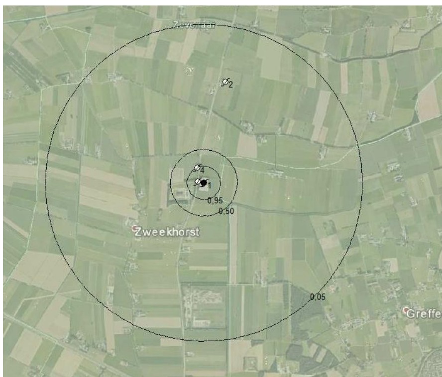
Figuur 11: Maximale reikwijdte en de 0,5 meter verlagingscontour bij bemaling onder GLG
