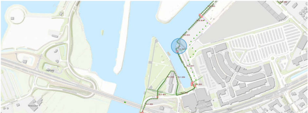
Figuur: locatie vervallen coupure, aanbrengen damwand
