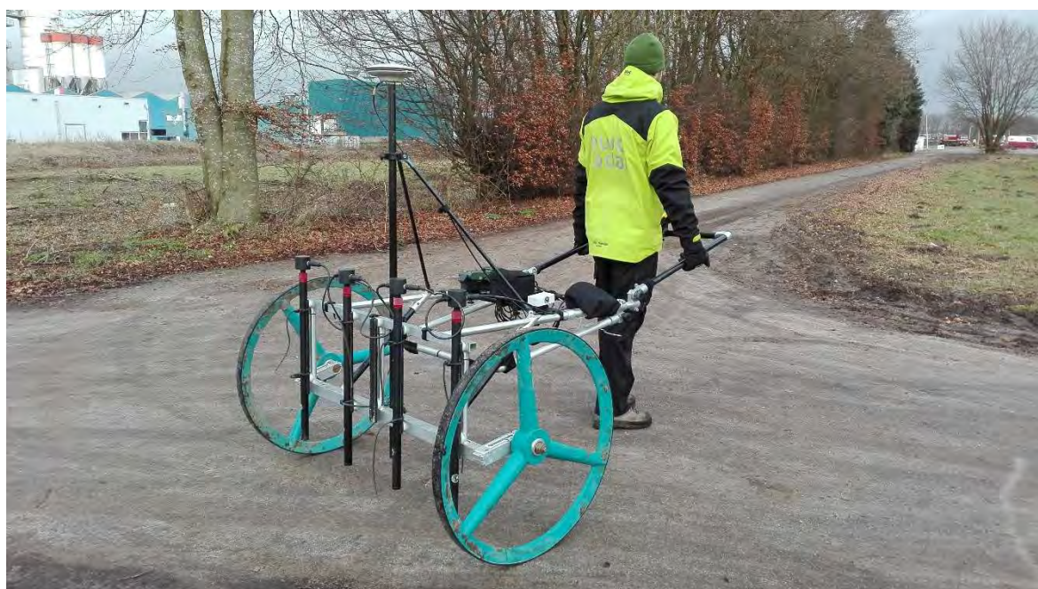
Figuur 6: Vallon multisondesysteem, DGPS ondersteund
