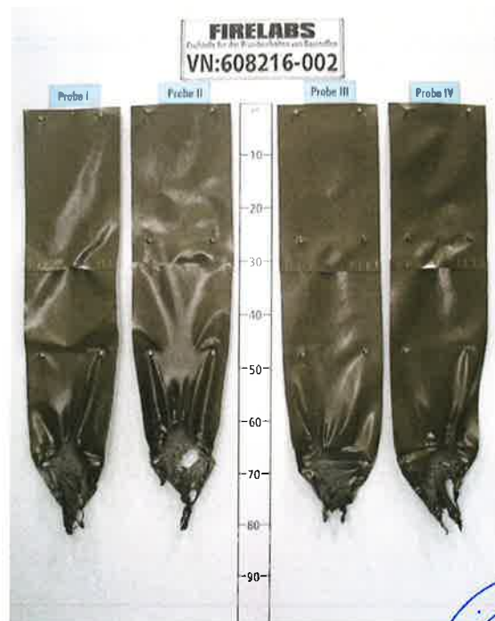
Bild 4 Aussehen des Probekörpers nach dem Brandversuch
