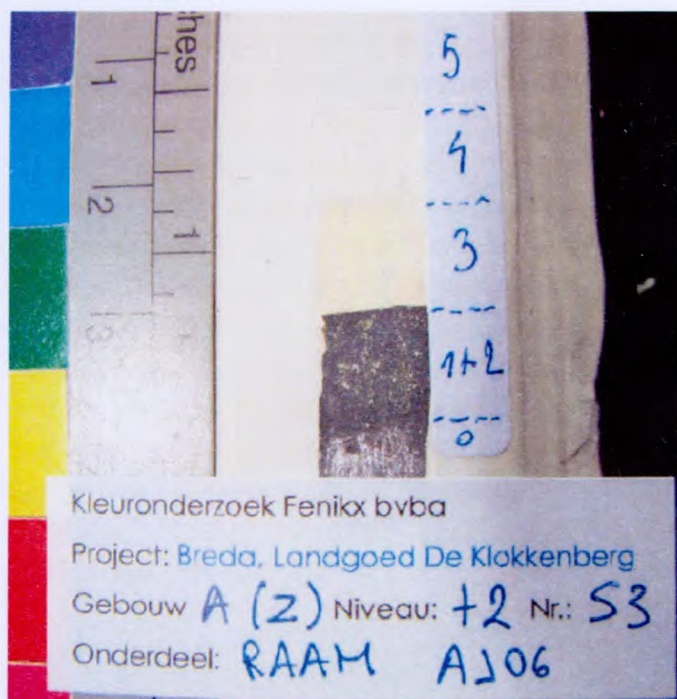
Steekproef op gebouw A: laag 3 is de eerste afwerking en bestaat uit een crème olievert (NCS 1010-Y)
