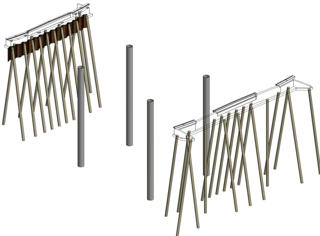
Figuur 9 Paalfundering en landhoofden
