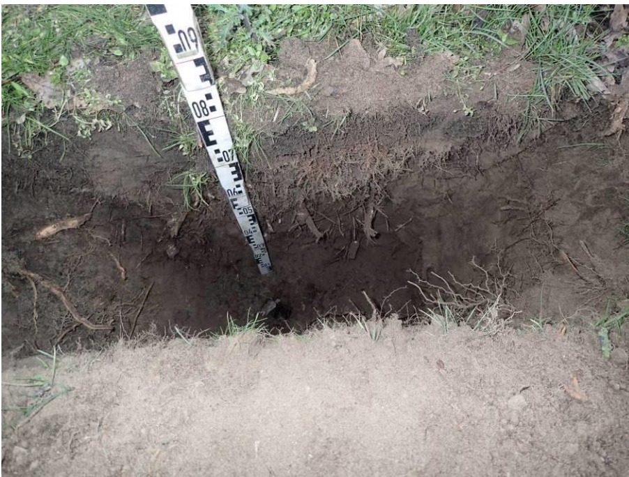
Foto 6: Profielsleuf 3 bij boomnummer 484054, gegraven op 55 cm vanaf hart stam. Representatief voor profielsleuf 2 en 4.
