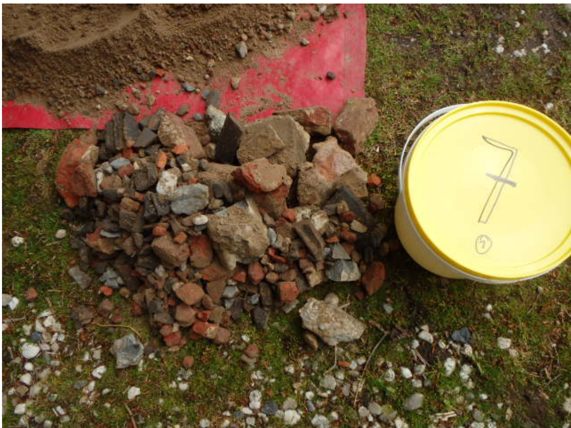
foto 4: uitkomend materiaal (grove fractie, >16\text{ mm} ) inspectiegat 7 ter plaatse van puinhoudende verhardingslaag (1 juni 2015)
