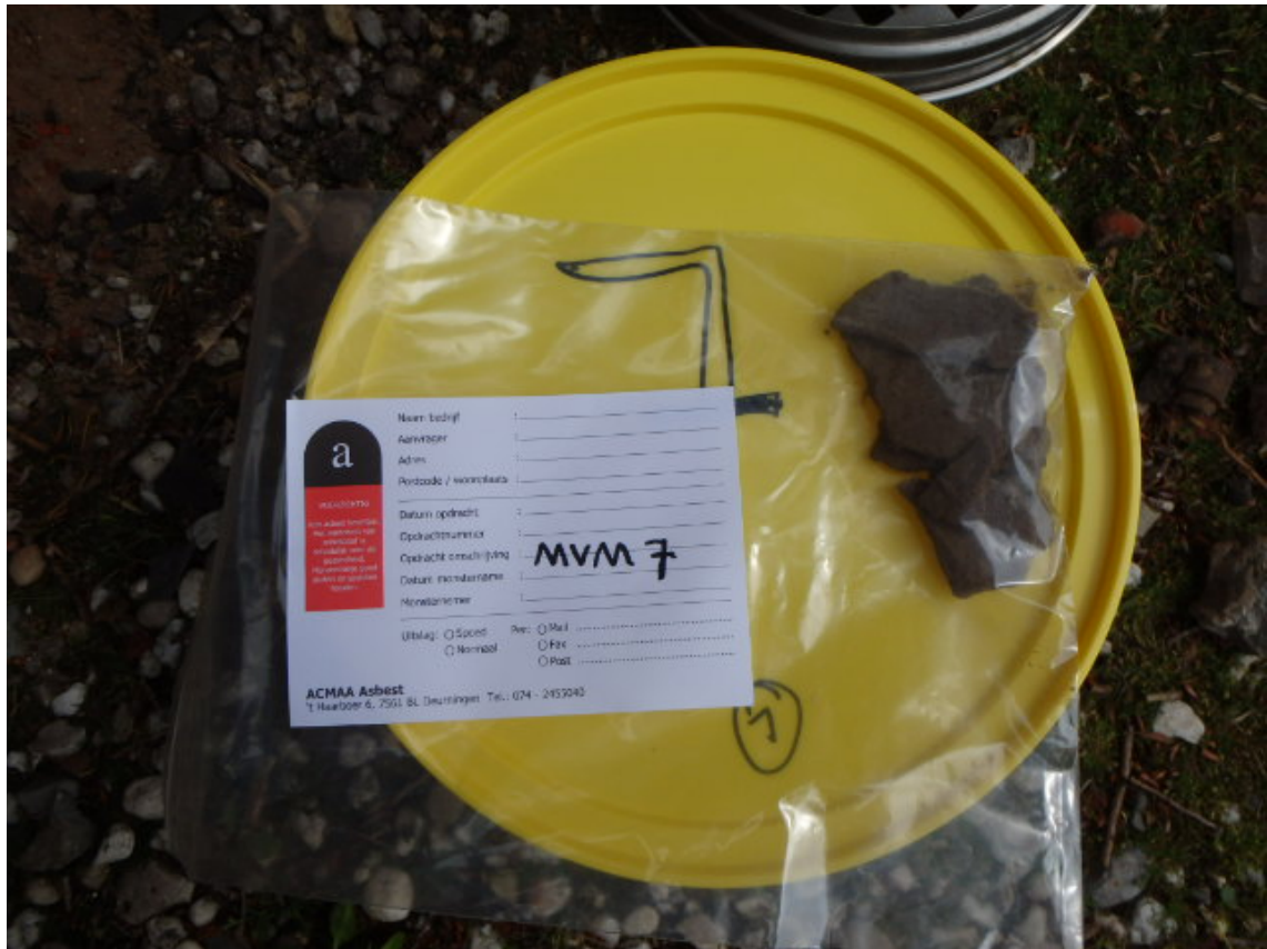
foto 5: asbestverdacht materiaal afkomstig uit inspectiegat 7 ter plaatse van puinhoudende verhardingslaag (1 juni 2015)
