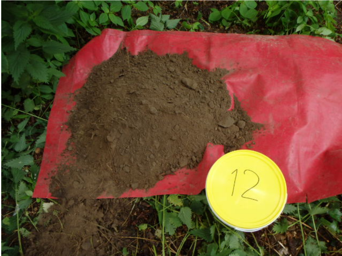
foto 9: uitkomend materiaal (fijne fractie, <math><16\text{ mm}</math>) inspectiegat 12 ter plaatse van asbestverdacht materiaal op maaiveld (1 juni 2015)
