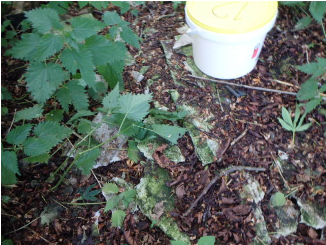
foto 7: asbestverdacht plaatmateriaal op noordwestelijk deel van de onderzoekslocatie (1 juni 2015)
