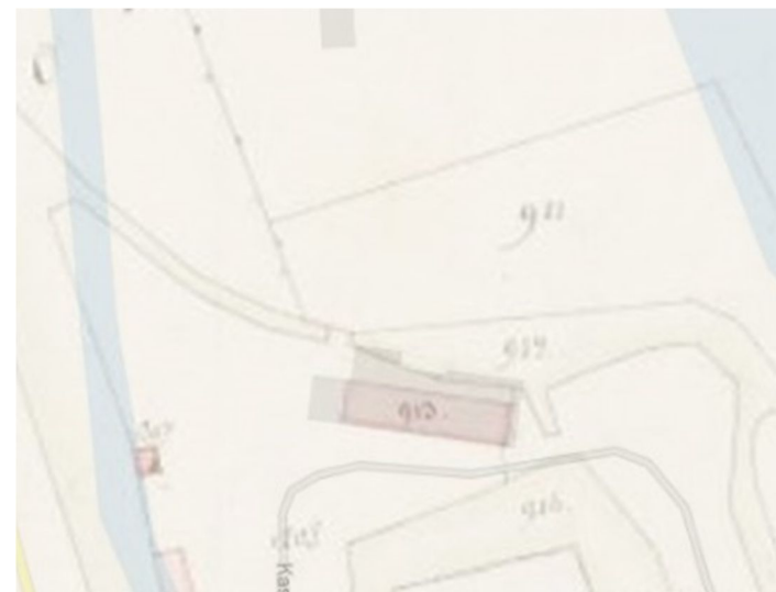
Afb. 96 Projectie van de minuutkaart uit 1811-1832 op een recente topografische onderlegger. We zien hier duidelijk hoe de woning en stal uit 1920, de uitbreiding uit 1980 en de houten schuurtjes buiten de contour van de tiendschuur vallen en deels met de fundering in het voormalige moeras/gracht zijn geplaatst.
