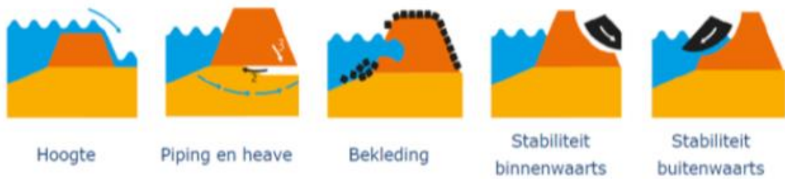
Figuur 4-2 van de verschillende faalmechanismen
