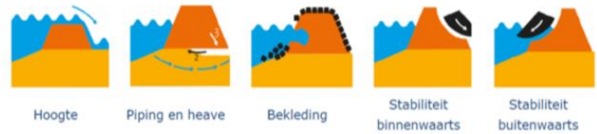
Figuur 4-4 van de verschillende faalmechanismen
