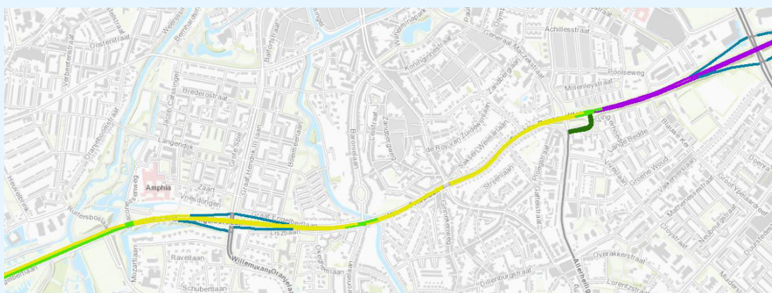
figuur 3: Wegdektypen huidig/toekomst (blauw en donkergroen= SMA, lichtgroen=wegdek reductie 3 dB, geel=wegdek reductie 4 dB, paars=Dubofalt reductie 4 dB)
