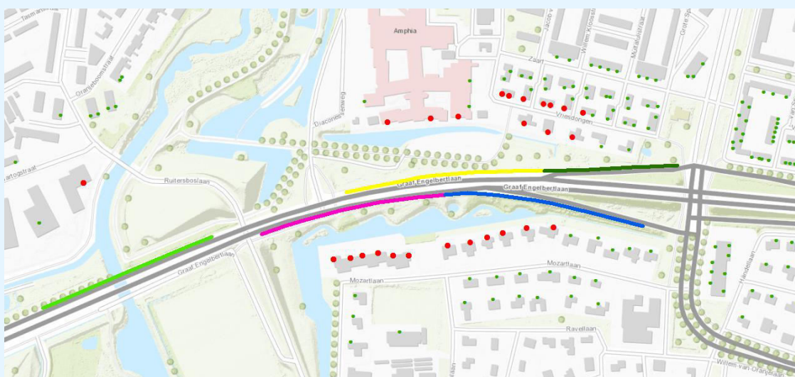
figuur 11: Schermen locatie westzijde variant 1A (donkergroen=1m, lichtgroen=1.5m, blauw=2m, geel=3m, roze=5m)
