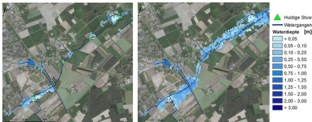
Figuur 3-15 Inundatiebeeld bovenstreams T10Wh huidige (links) en T10Wh Beekherstel (rechts)
