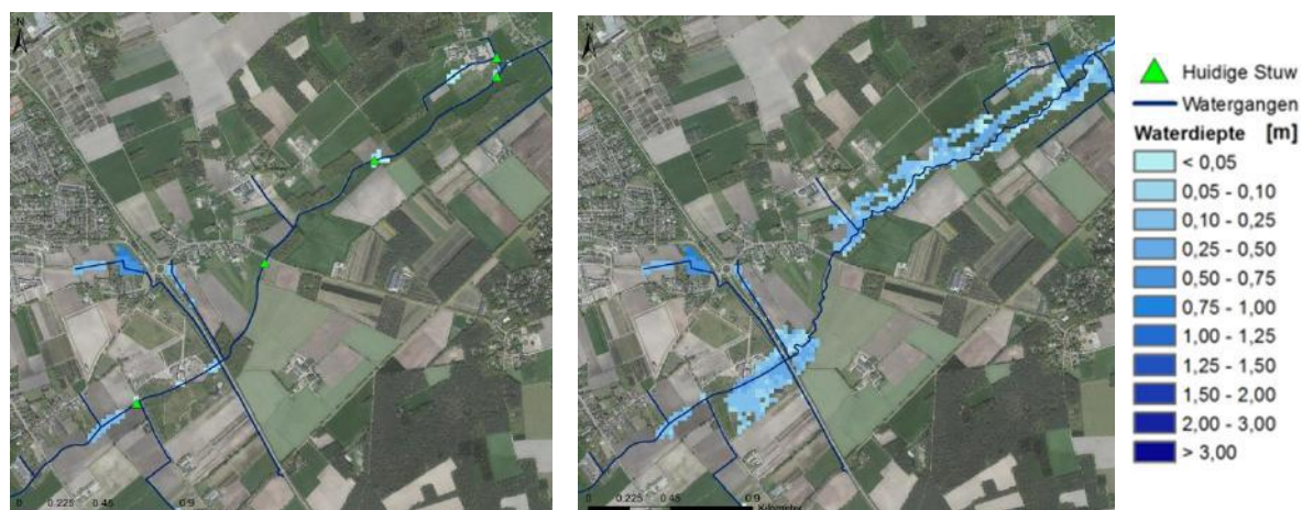
Figuur 3-14 Inundatiebeeld bovenstreams T1Wh huidige (links) en T1Wh Beekherstel (rechts)
