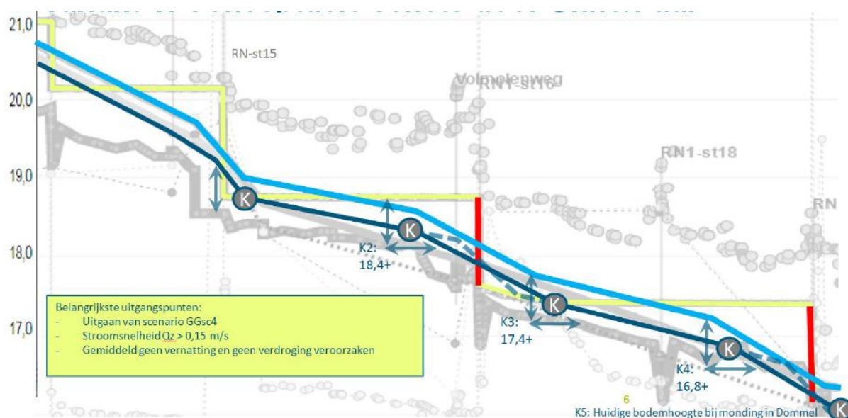
Figuur 3-8 Locatie knikpunten variant 1B in langsvprofiel. De bodemhoogte van de knikpunten is weergegeven in m+NAP
